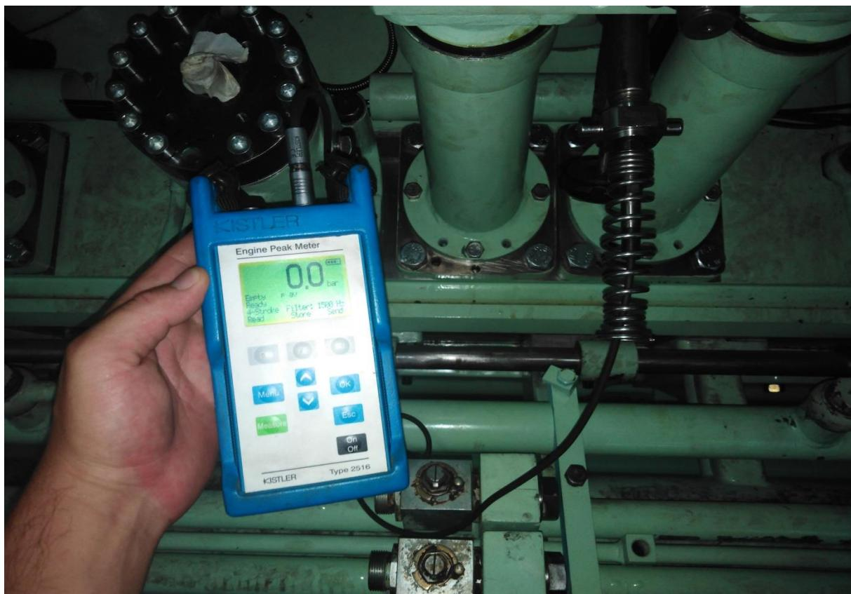
Slika 37. Predodžba mjerjenja maksimalnih tlakova za vrijeme terećenja \*\*
