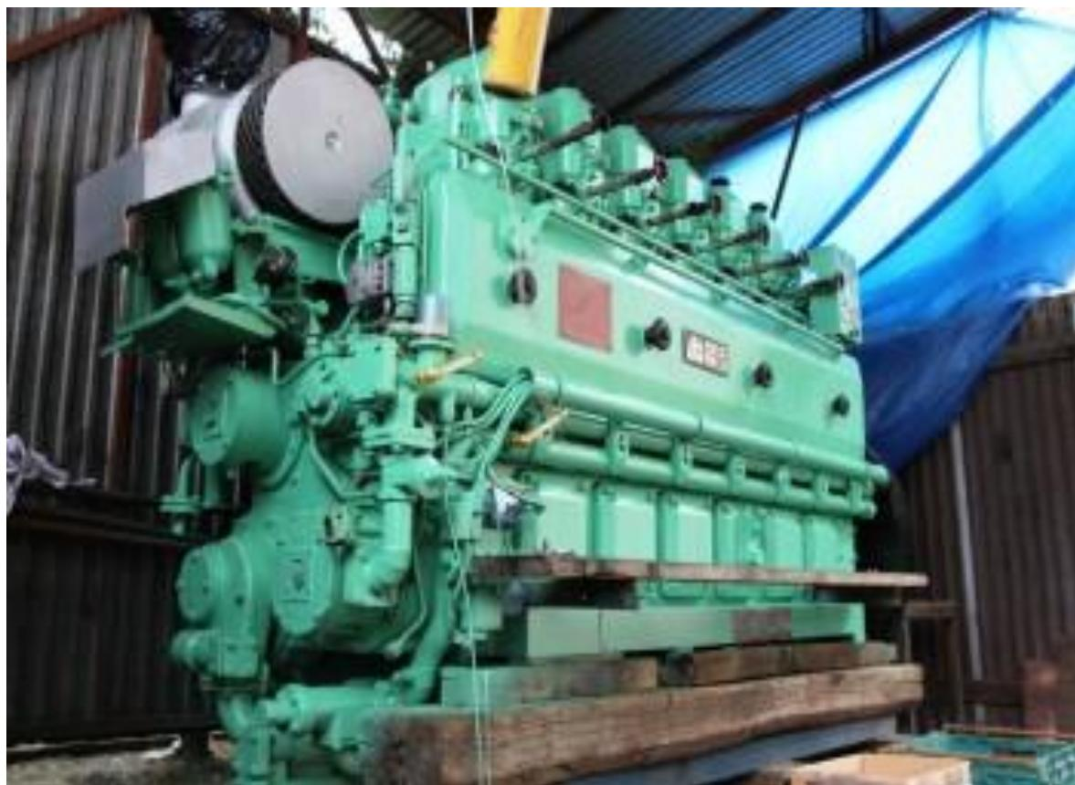
Slika 05. Diesel motor Sulzer A20 [5]
