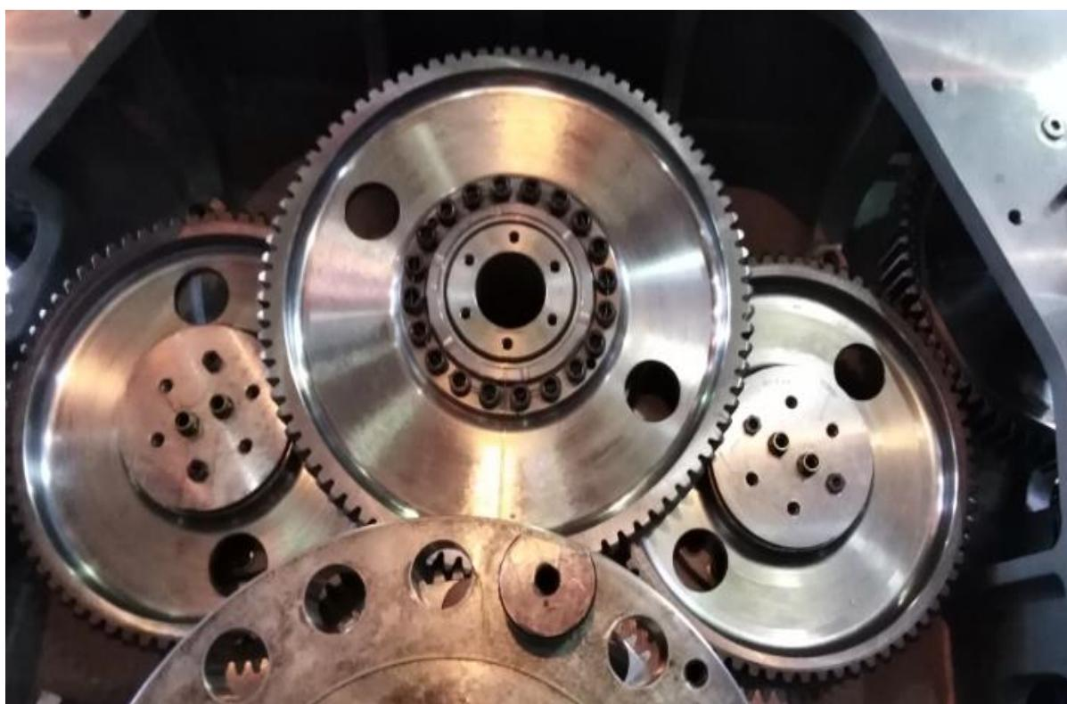
Slika 19. Predodžba razvodnog mehanizma \*
