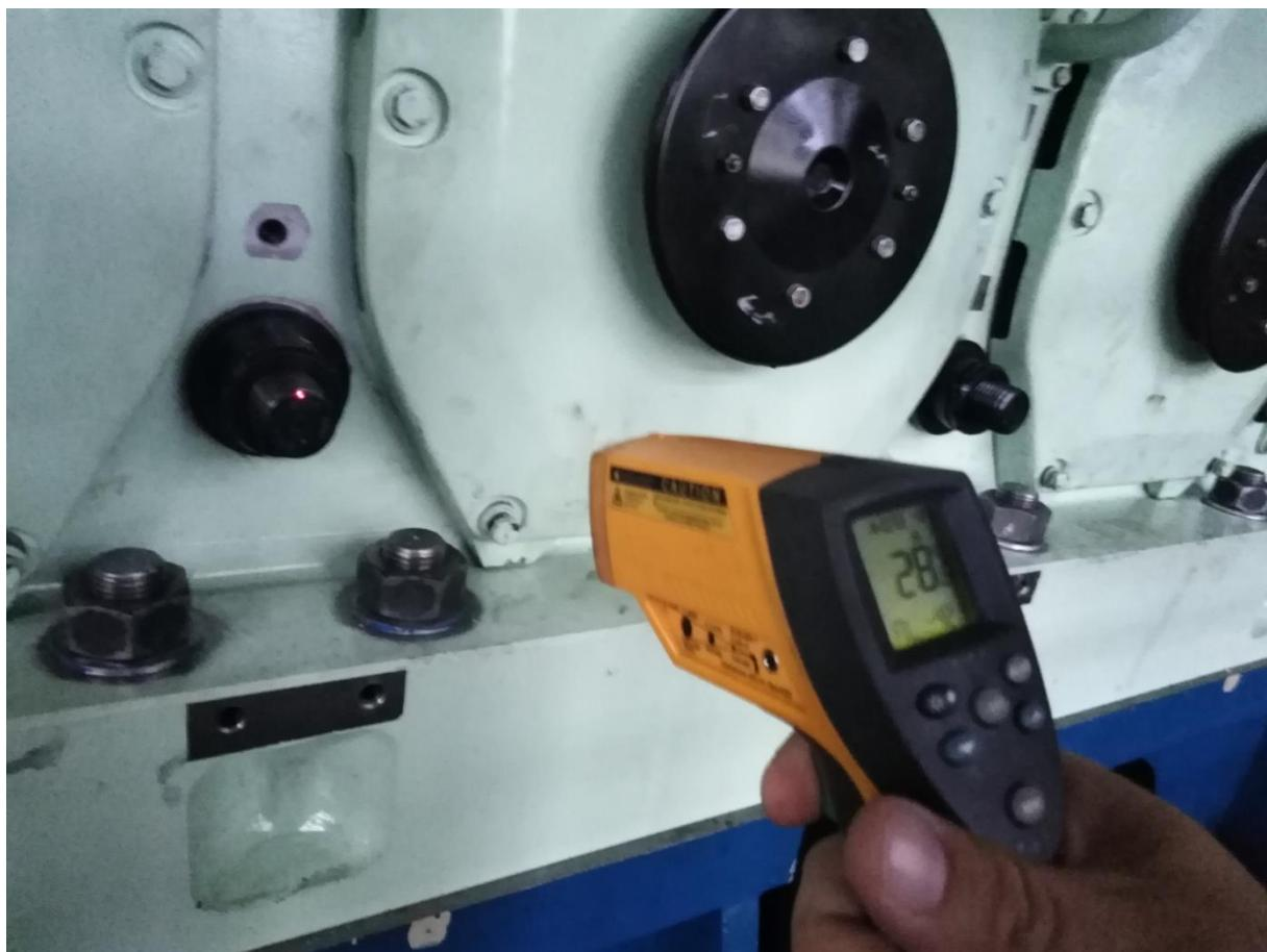
Slika 36. Predodžba mjerena temperature temeljnih ležajeva tijekom ispitivanja \*\*
