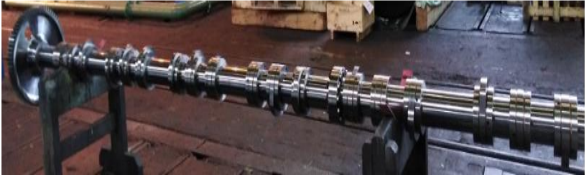
Slika 18. Predodžba složenog bregastog vratila **
