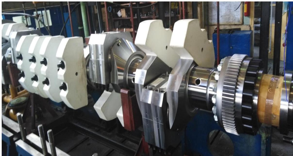
Slika 11. Predodžba koljenastog vratila ADRIA 40 s montiranim protuutezima, letećim ležajevima i odrivnom osovinom \*\*
