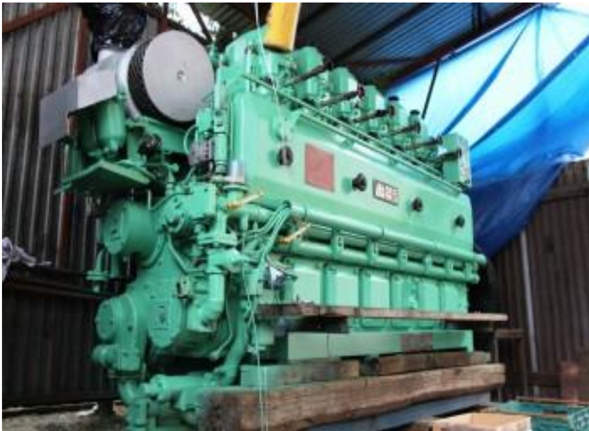
Slika 05. Diesel motor Sulzer A20 [5]
