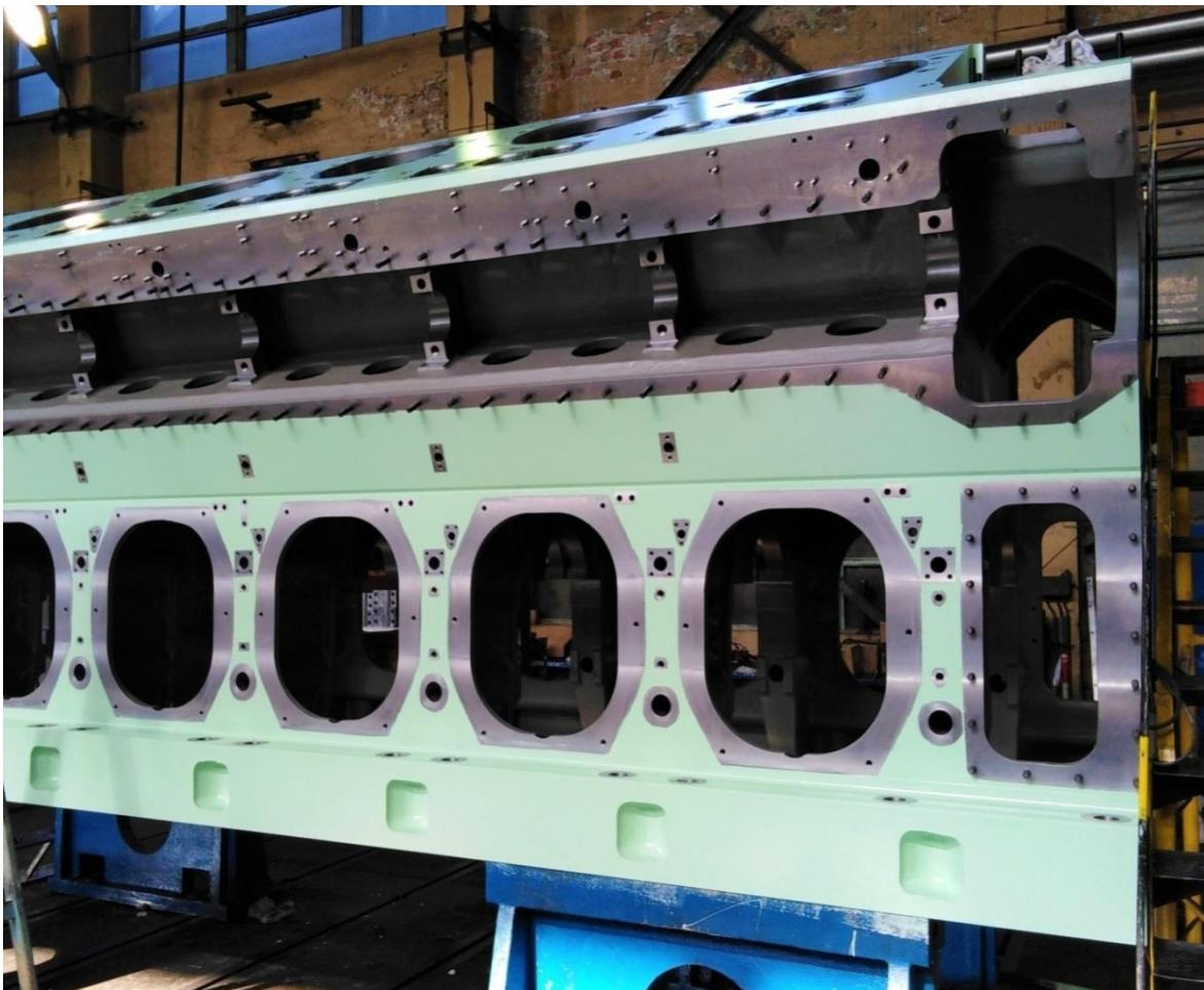
Slika 09. Predodžba kućišta motora ADRIA 40 prije montaže dijelova \*\*
