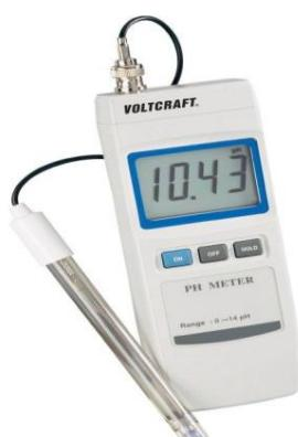
**Slika 3.** pH metar (lat. *potentiahydrogenii*: snaga vodika)
