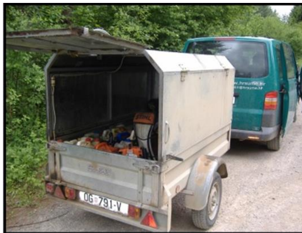
Slika 26 - Ispravan način prijevoza alata i goriva upotrebom prikolice
