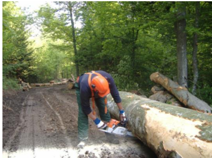
Slika 21 - Prerezivanje na pomoćnom stovarištu
