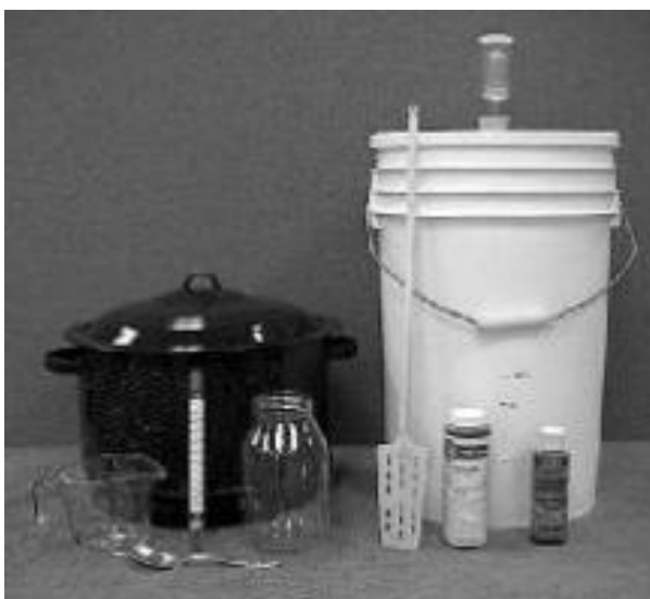
Slika 6. Minimalna oprema za proizvodnju piva u kućnom pivarstvu (Palmer, 2006.)
