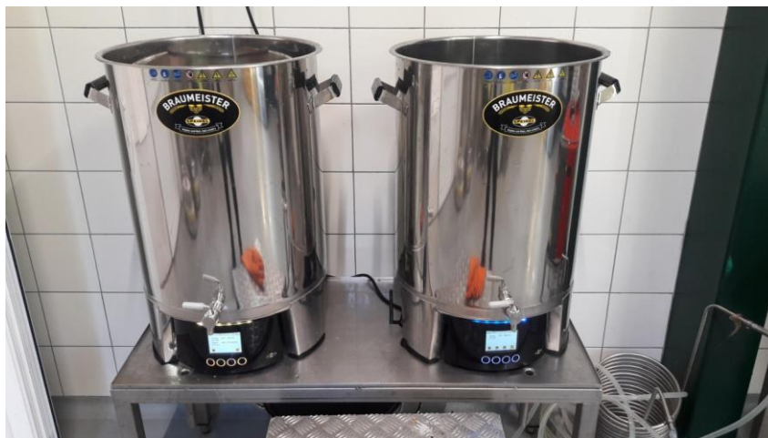
Slika 8. Speidels Braumeister oprema za proizvodnju piva
