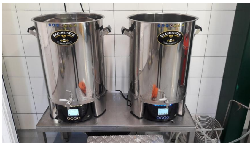
Slika 8. Speidels Braumeister oprema za proizvodnju piva
