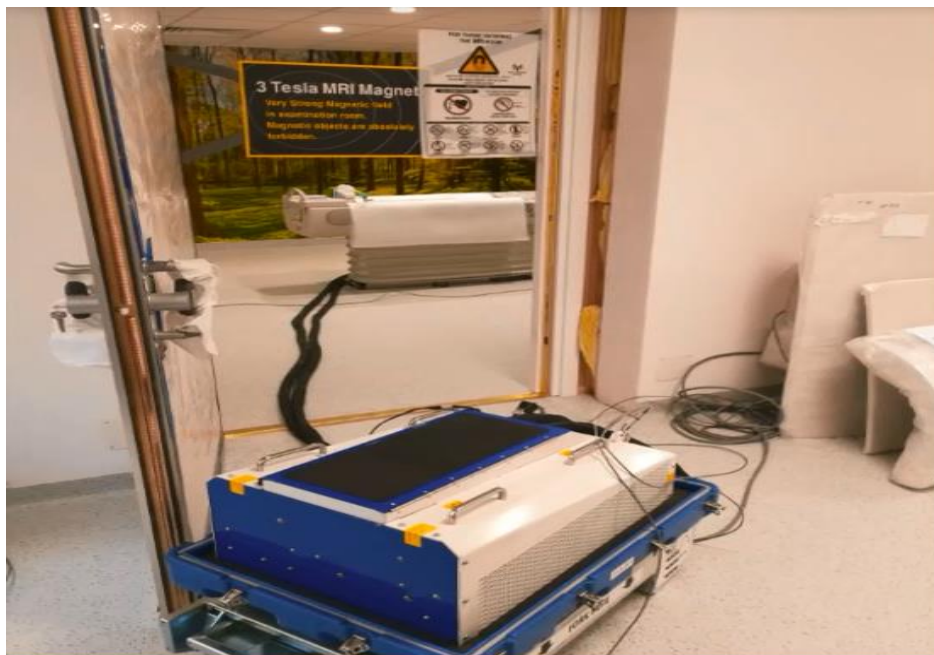
Slika 16. Predodžba MPSU/uređaj za dizanje i spužtanje magnetskog polja. Izvorno autor.
