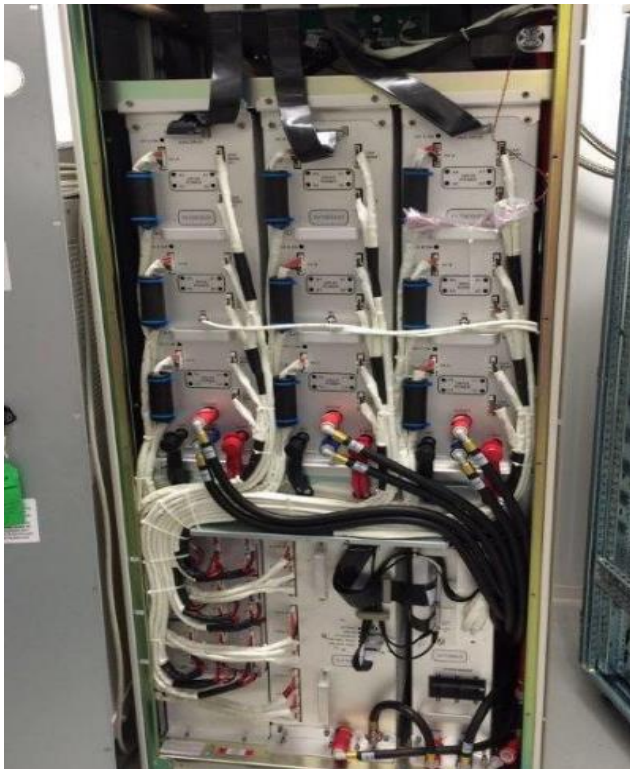
Slika 8. Predodžba gradijentnog pojačala. Izvorno autor.
