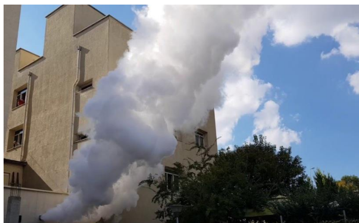
Slika 20. Predodžba eksplozije tekućeg helija/quench magneta. Izvor: Wikipedija
