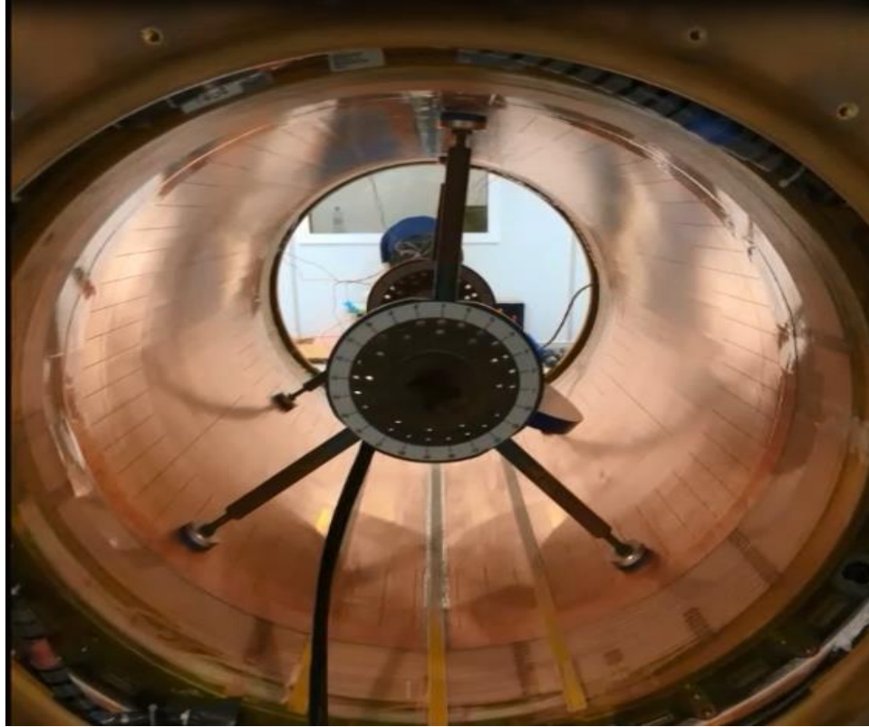
Slika 15. Predodžba field kamera u jezgri magneta. Izvorno autor.
