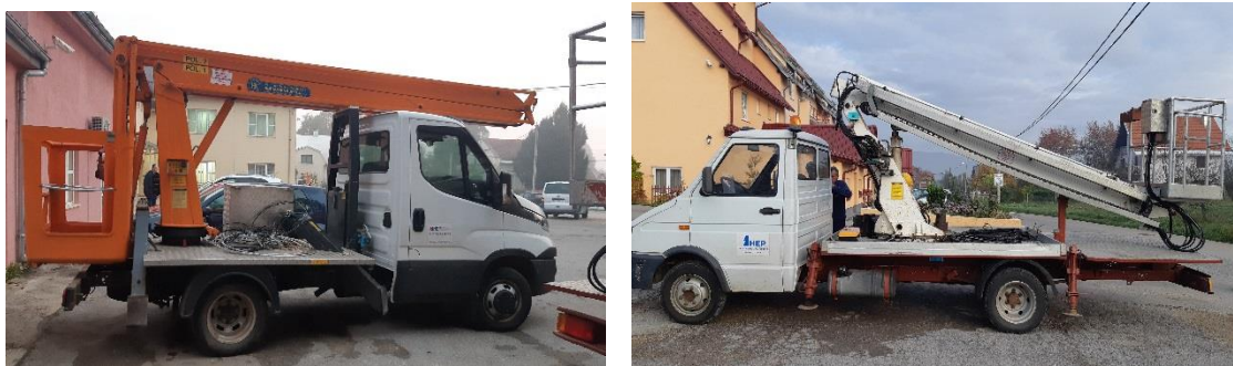
Slika 11. Prikaz hidraulične auto-platforme s košarom
