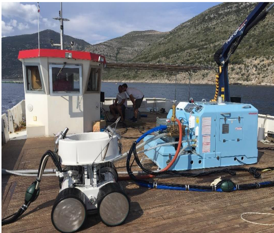
Sl. 16. Robot za čišćenje kaveza [18]
