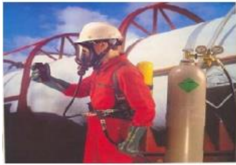
Slika 27: Cijevni uređaj s priključkom na izvor komprimiranog zraka [1]
