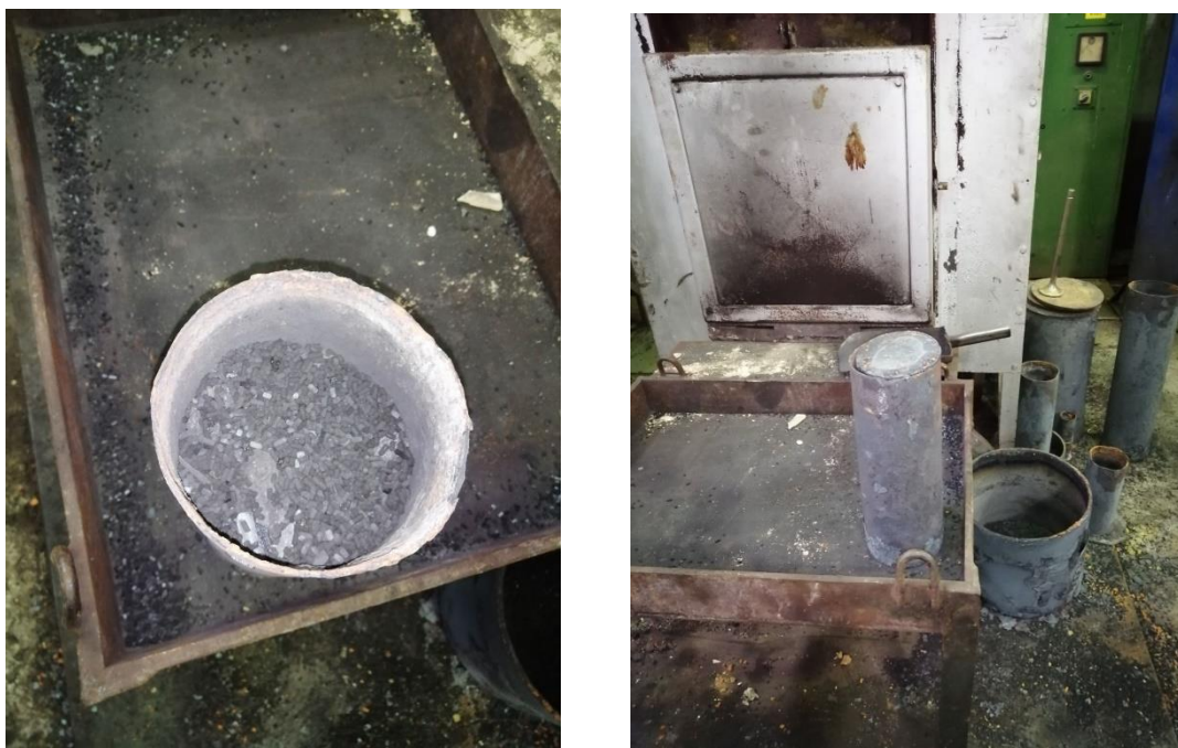
Slika 24 - Prikaz zatvorene posude za pougljičavanje [9]
