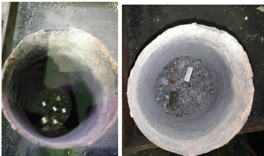
Slika 23 - Pozicioniranje uzoraka u posudu za pougljičavanje [9]
