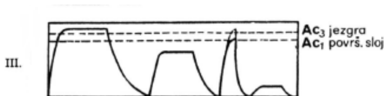
Slika 13 - Jednostruko kaljenje nakon međuzarenja [3]
