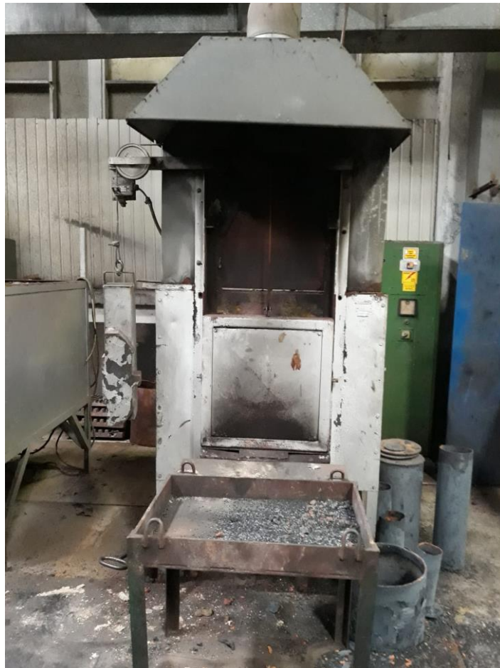
Slika 25 - Komorna elektro peć [9]
