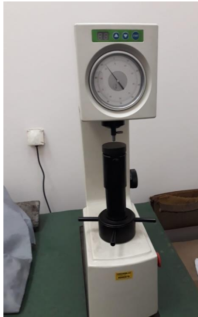
Slika 29 - Mjerni uređaj za ispitivanje tvrdoće [9]
