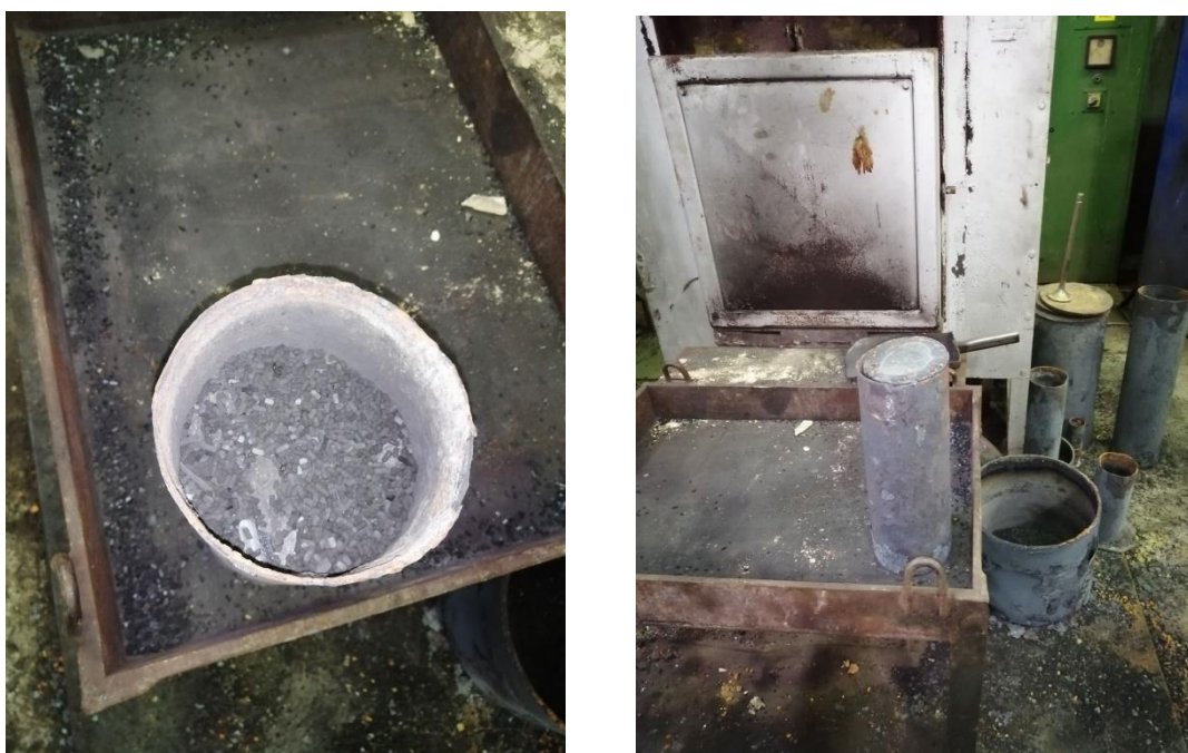
Slika 24 - Prikaz zatvorene posude za pougljičavanje [9]
