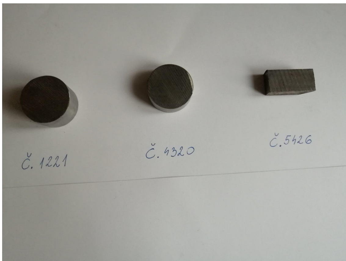
Slika 21 - Izgled uzoraka prije pougličavanja [9]
