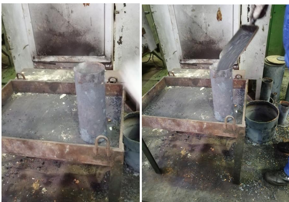
Slika 22 - Posuda za pougljičavanje [9]
