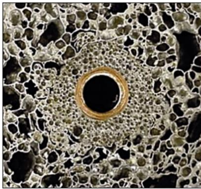
Slika 39. Komadi metalne pjene s bakrenim umetkom [1]
