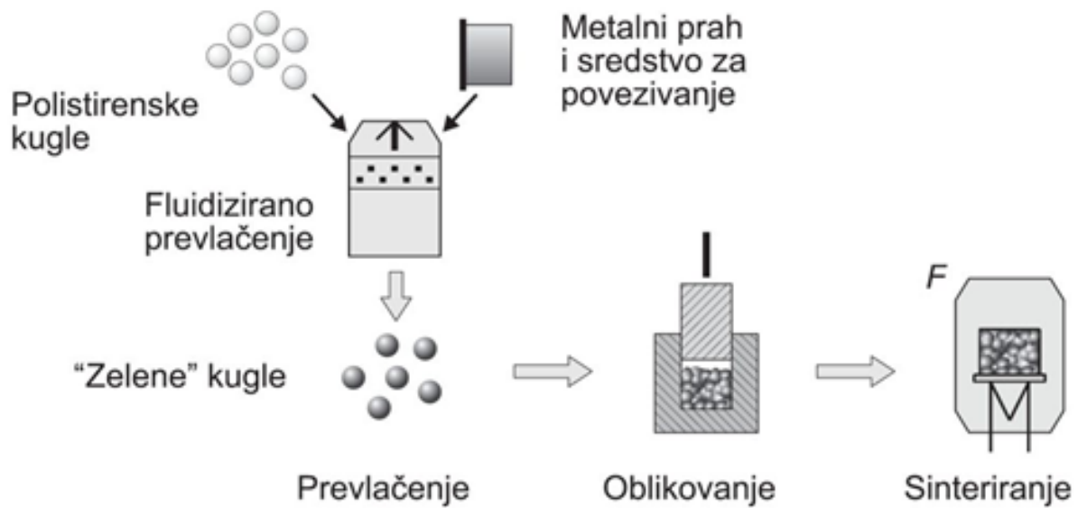
Slika 13. Proces nastajanja metalne pjene s kuglastim šupljinama IFAM postupkom [1]
