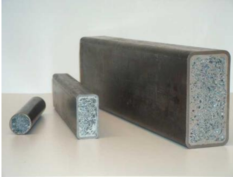
Slika 36. Sendvič-konstrukcija s jezgrom od metalne pjene [11]
