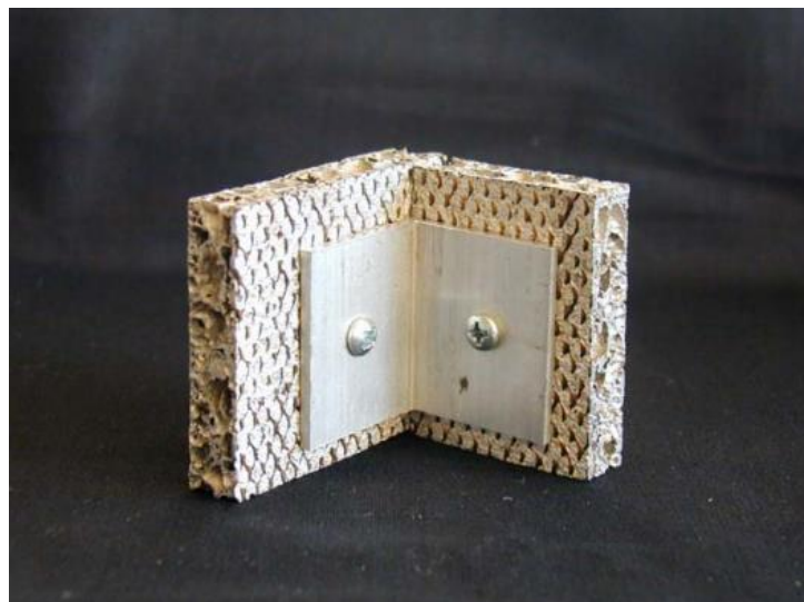
Slika 40. Rastavljivo spajanje metalnih pjena [10]
