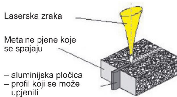
Slika 41. Lasersko zavarivanje metalne pjene [1]
