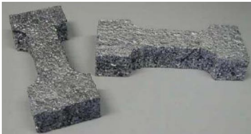
Slika 26. Uzorci za ispitivanje vlačne čvrstoće u obliku kosti [6]
