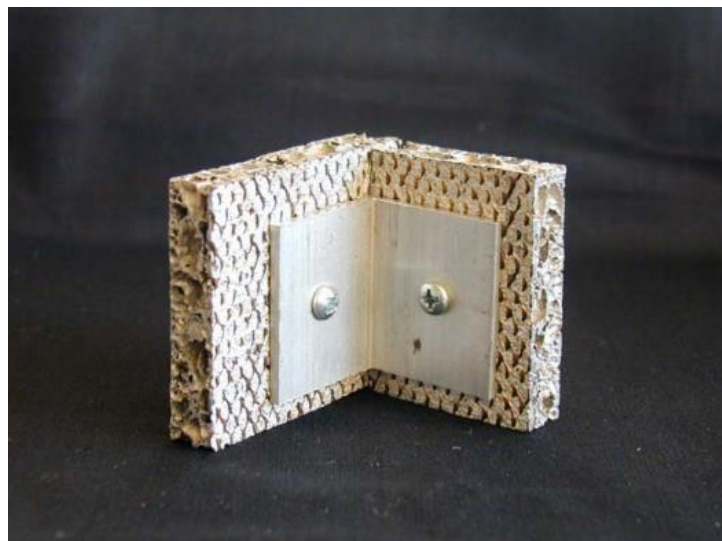
Slika 40. Rastavljivo spajanje metalnih pjena [10]
