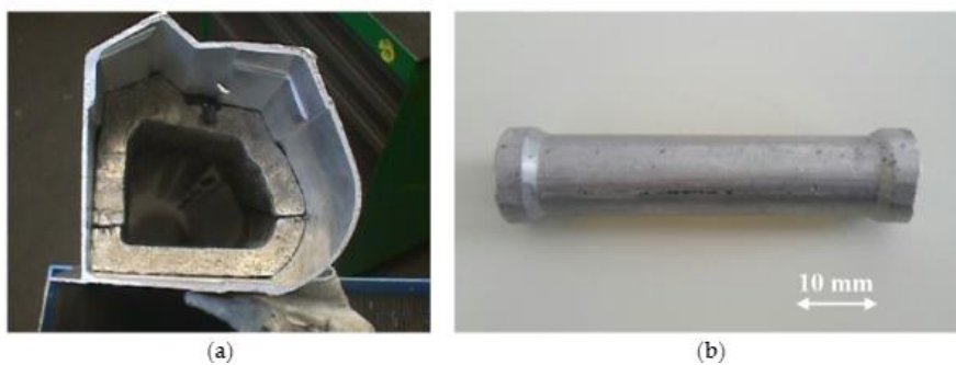
Slika 46. a) Al pjenasti dio za Ferrari 360 b) mali element koji apsorbira pad sustava za Audi Q7 [12]
