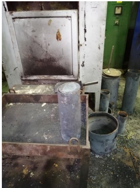
Slika 21. Prikaz pripremljene čelične kutije za proces pougljičenja [10]
