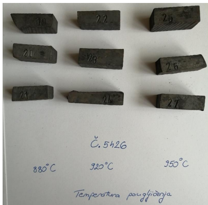
Slika 24. Uzorci Č.5426 nakon postupka cementacije [10]
