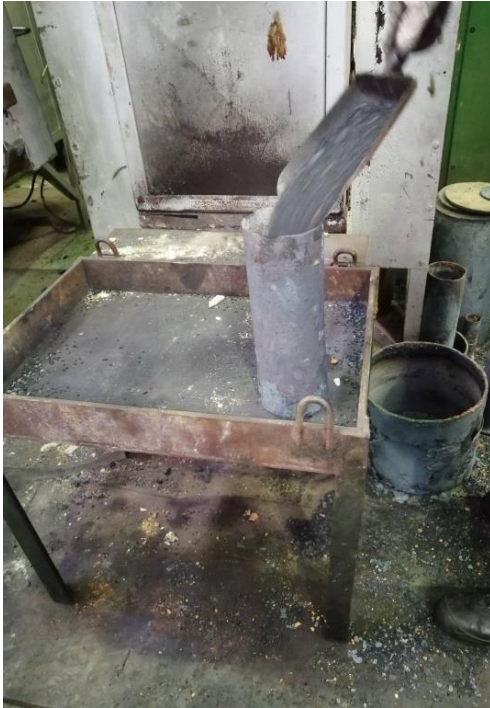
Slika 20. Priprema i pozicioniranje uzoraka u čeličnu kutiju [10]
