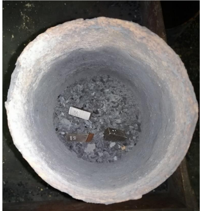
Slika 20. Priprema i pozicioniranje uzoraka u čeličnu kutiju [10]
