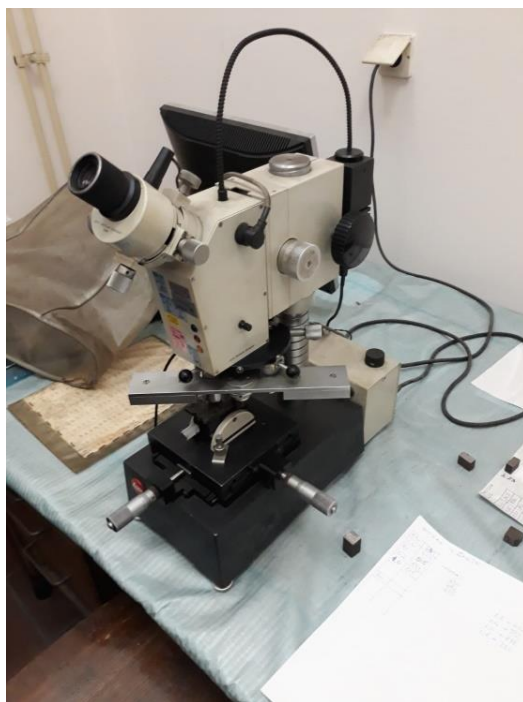
Slika 28. LEITZ Durimet 2 mikroskop [10]
