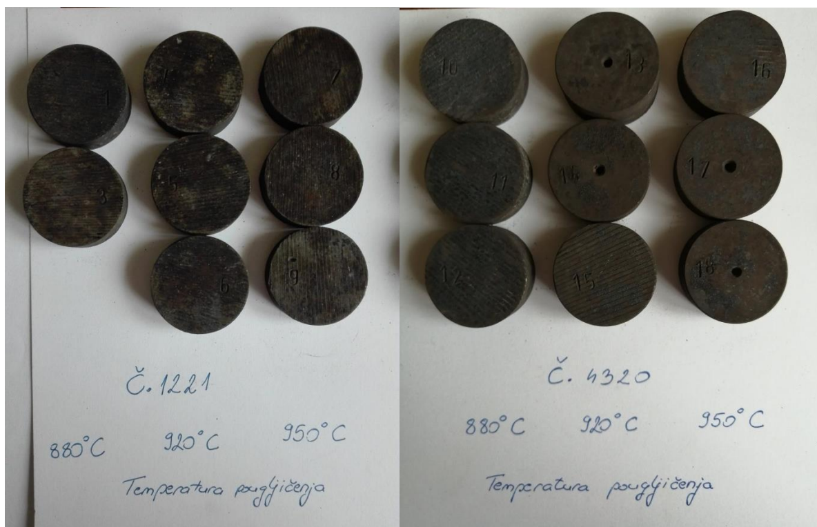
Slika 23. Uzorci Č.1221 i Č.4320 nakon postupka cementacije [10]
