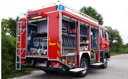
Slika 3 - Navalno vatrogasno vozilo tipa TLF 20/25-2 [10]
