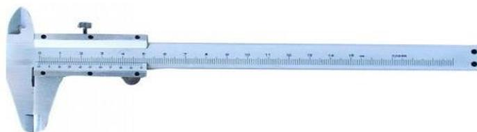
Sl. 40. Mehanička pomična mjerka [35]
