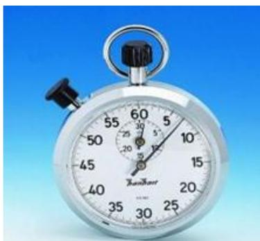
Sl. 31. Mehanički zaporni sat [34]
