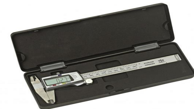
Sl. 41. Digitalna pomična mjerka [35]
