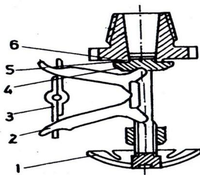
Sl. 16. Dijelovi sprinkler mlaznice s topivim elementom [13]
