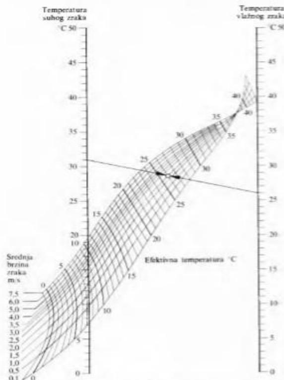
Sl. 11. Nonogram za određivanje efektivne temperature [14]
