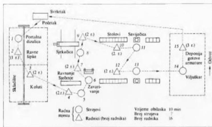
Sl. 14. Tlocrt armitračnice s oznakom radnih mesta, broja radnika i smjera obilaska za primjenu metode trenutnih opažanja [12]
