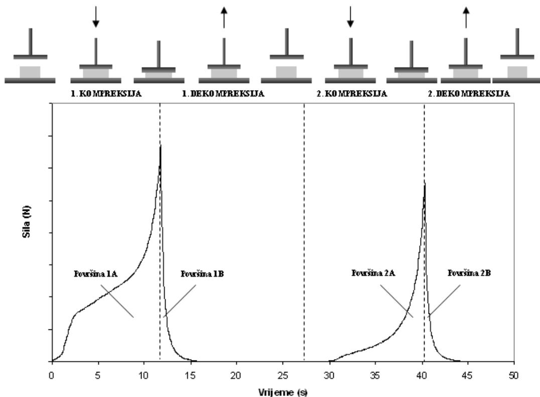
Slika 13. Tipična krivulja ispitivanja teksturalnog profila metodom dvostrukog kompresije
