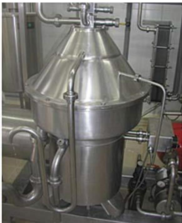
**Slika 3.** Centrifugalni separator
