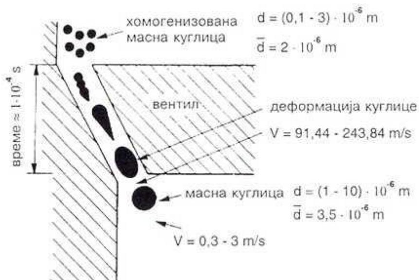
**Slika 5.** Shematski prikaz homogenizacije mlijeka
