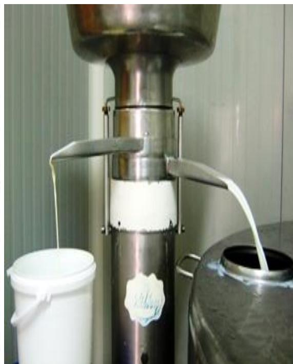
**Slika 4.** Centrifugalni separator
