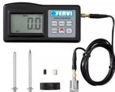
Slika 9. Mjerač vibracija
