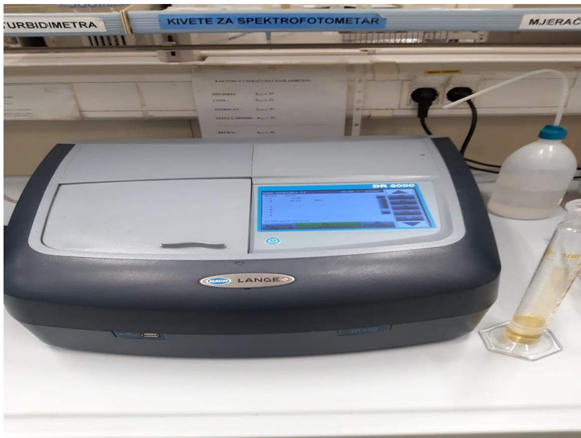
Slika 8. UV Spektrofotometar i menzura za pripremu otopine
