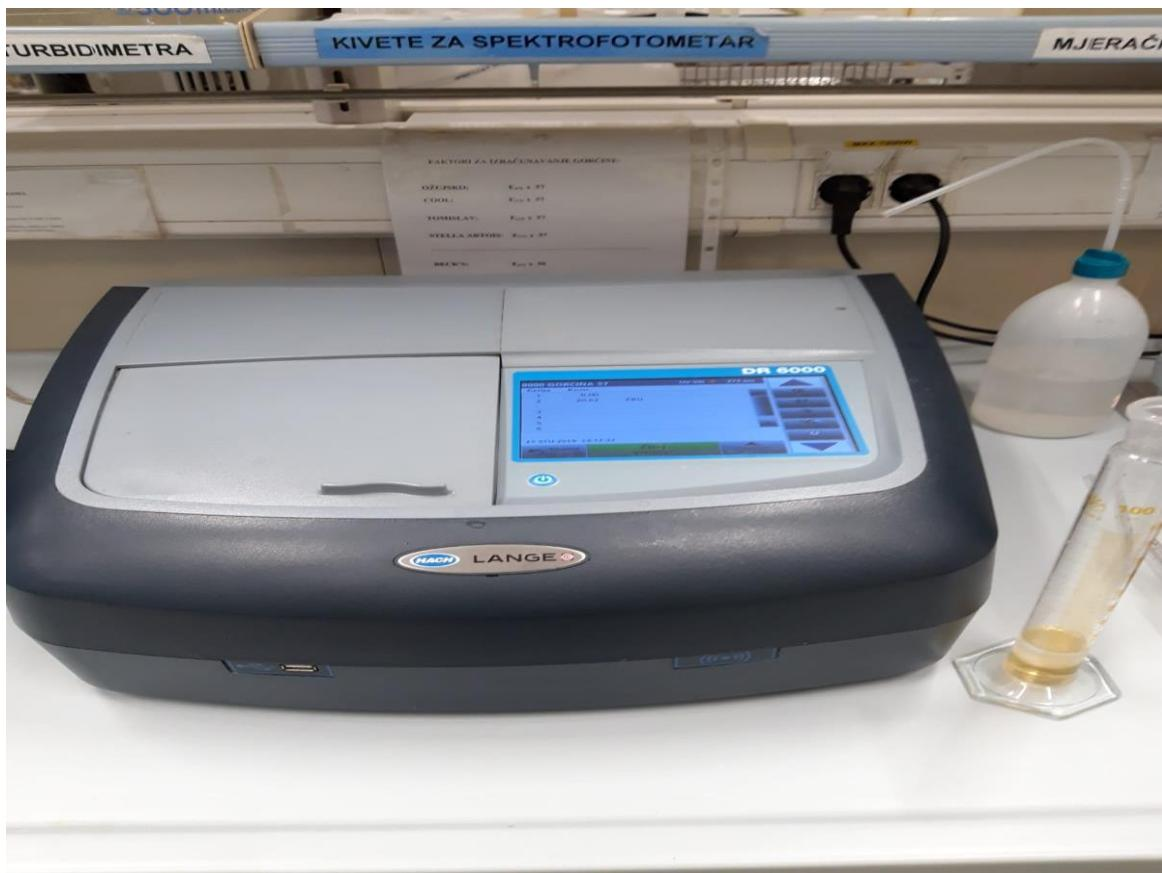
Slika 8. UV Spektrofotometar i menzura za pripremu otopine
