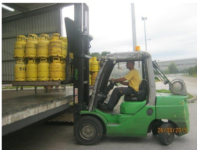
Slika 51. Skidanje palete s platoa
