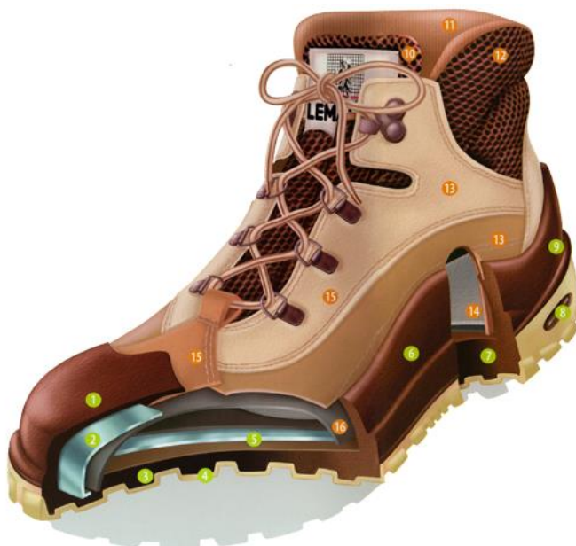
Slika 22. Presjek zaštitne cipele
