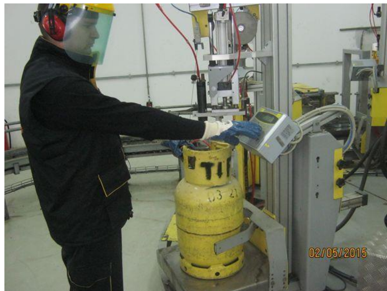
Slika 58. Punitelj plinskih boca
