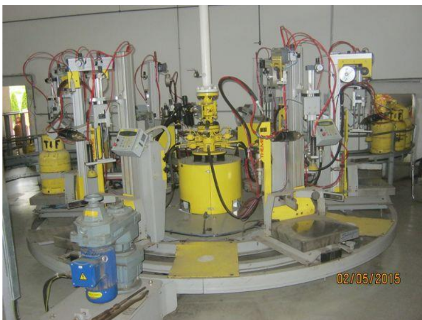
Slika 43. Karusel u punionici boca
