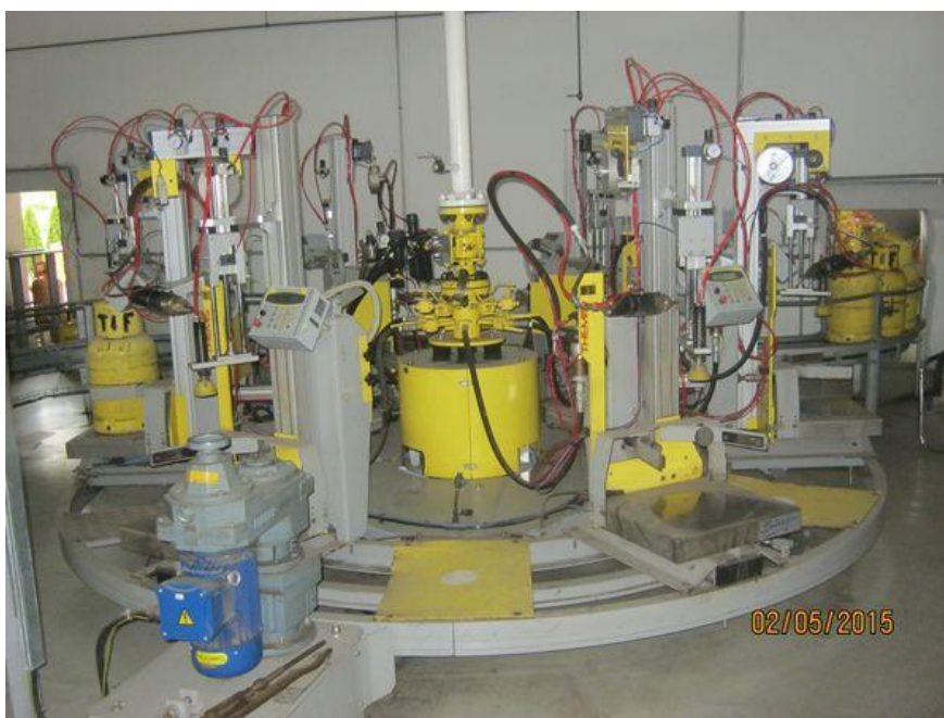
Slika 43. Karusel u punionici boca
