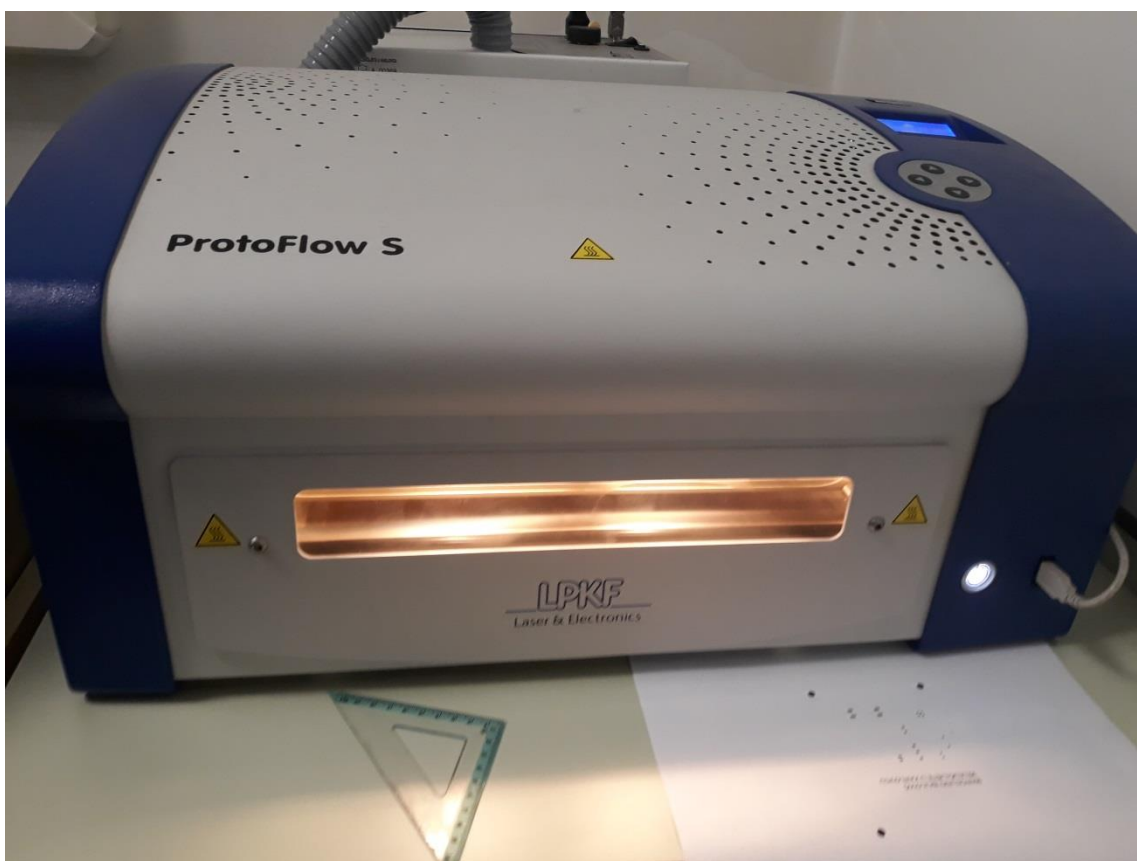
Slika 27 ProtoFlow S "pećnica"
