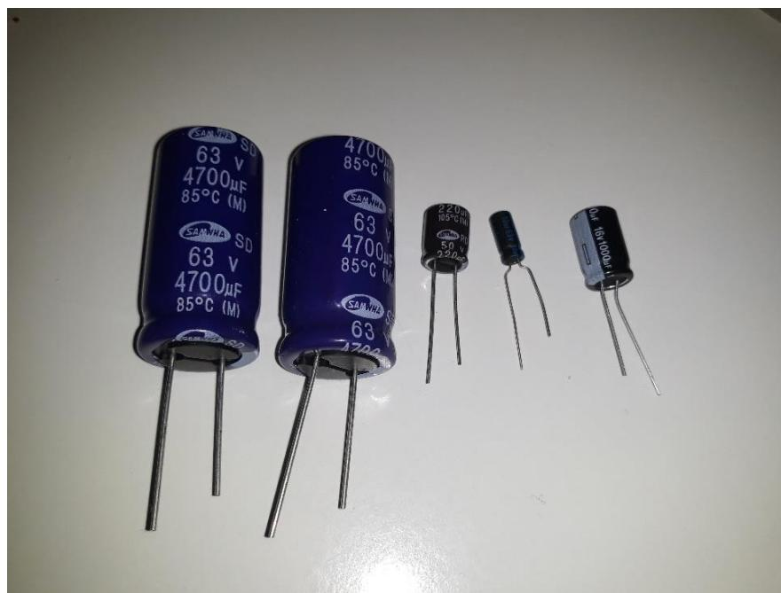
Slika 10 Korišteni elektrolitski kondenzatori
