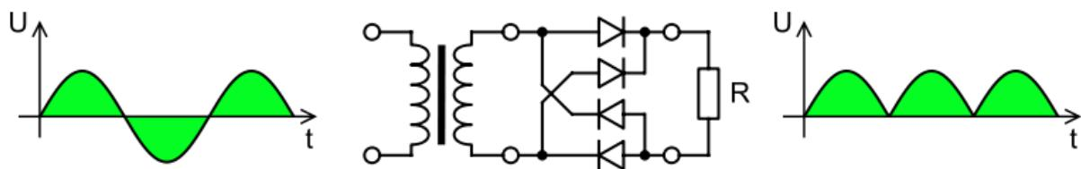
Korišten je Graetzov spoj u metalnom kućištu, 25A/125V. U ovom slučaju Graetz je korišten kao 2 spoja s 2 diode zbog simetričnog napajanja.
