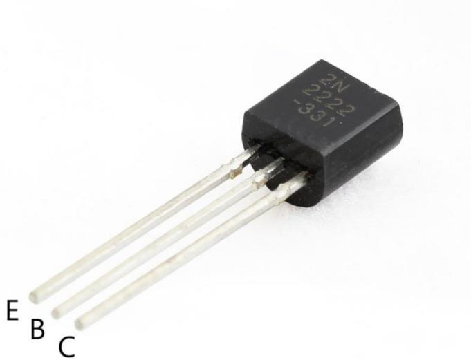
Slika 12 Vrste i izgled bipolarnog tranzistora [11]
