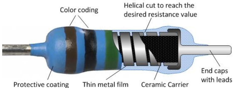
Slika 7 Struktura otpornika [8]
