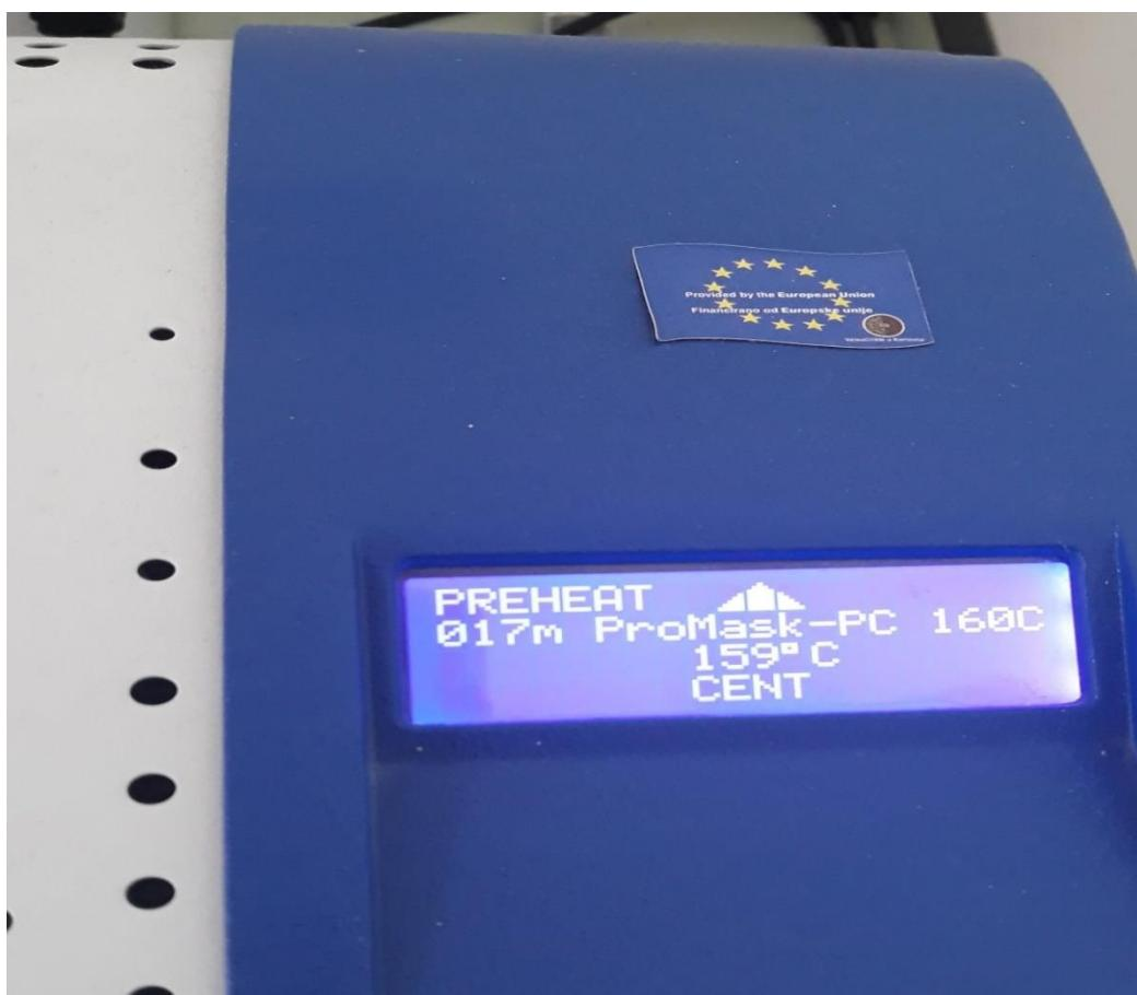
Slika 28 Grijanje pločice
