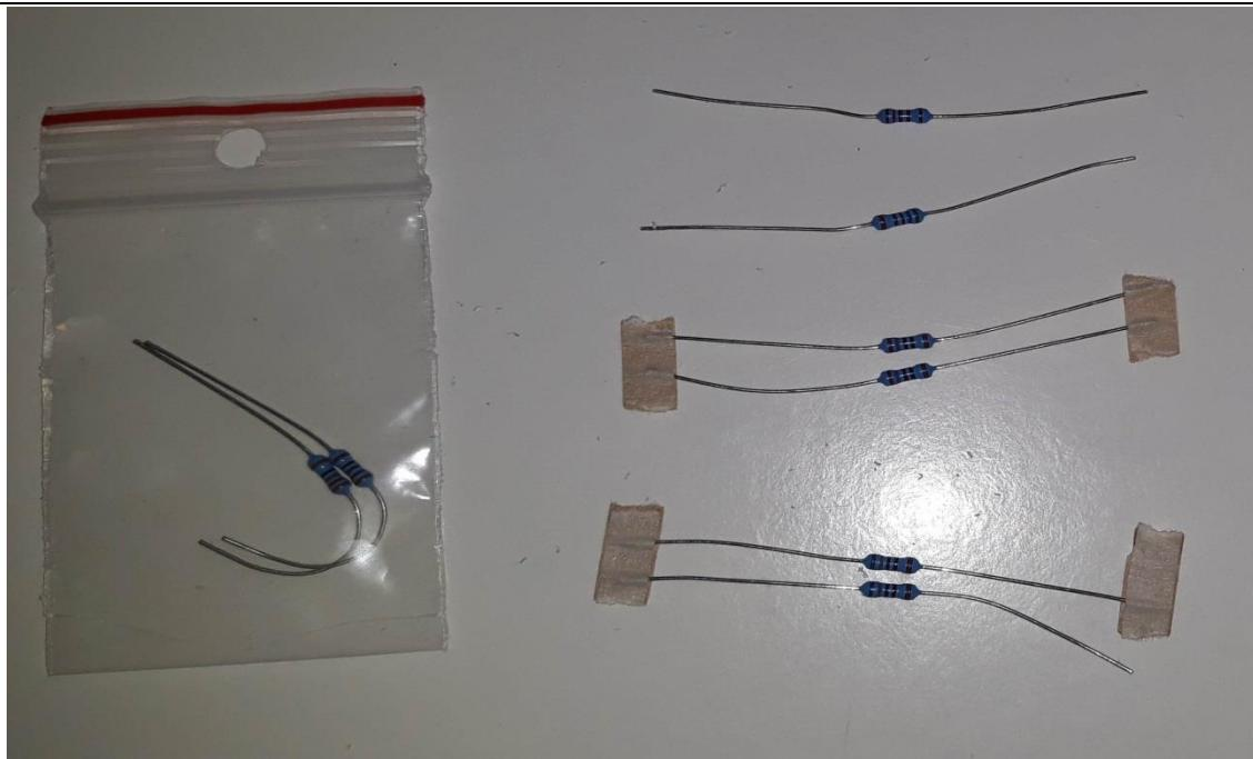
Slika 8 Korišteni stalni otpornici
