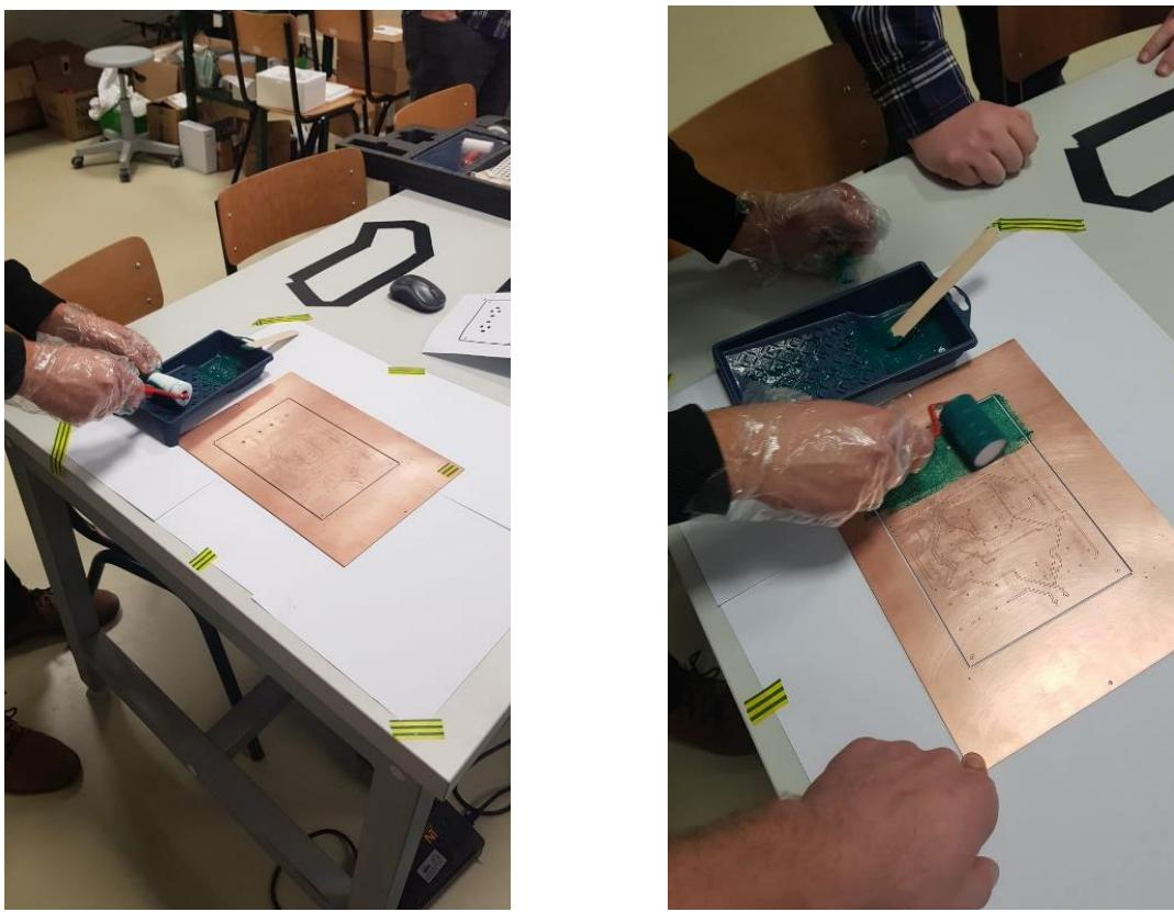
Slika 26 Premazivanje pločice maskom za lemljenje
