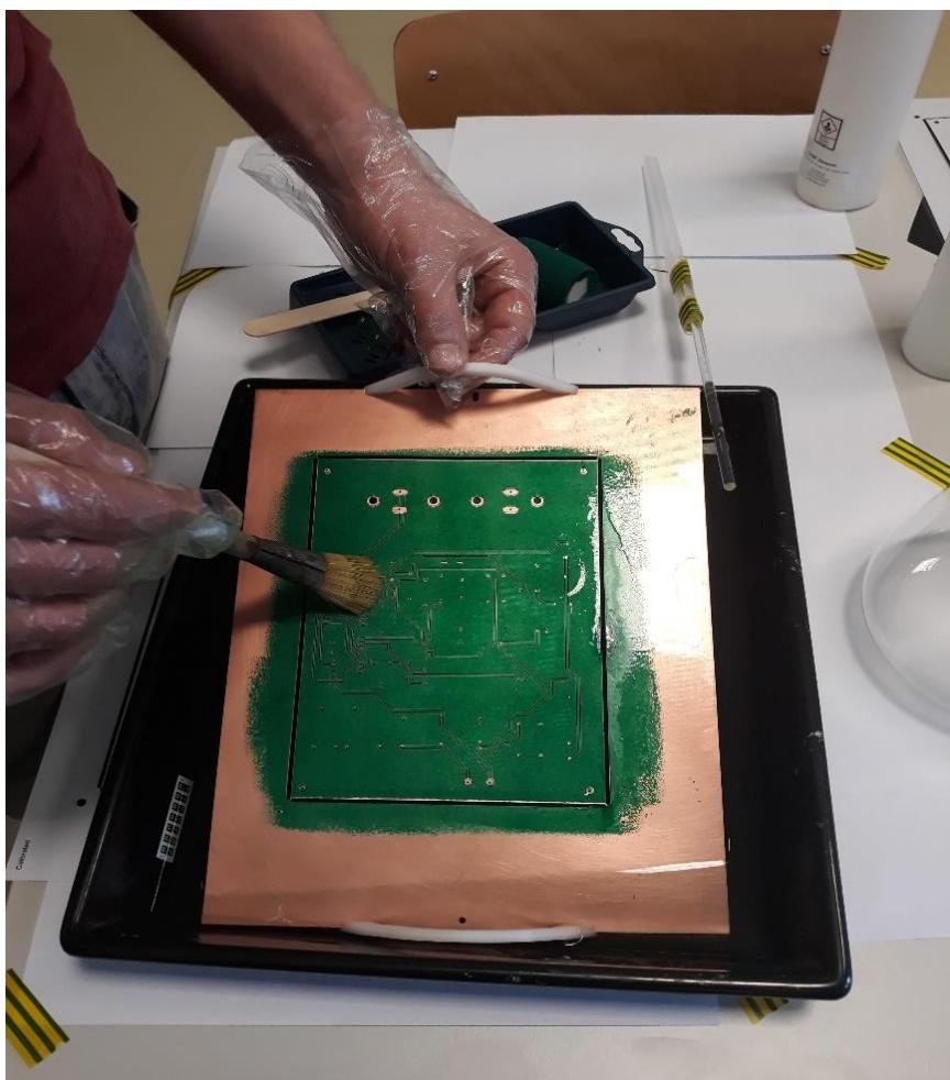
Slika 31 Uklanjanje slojeva maske
