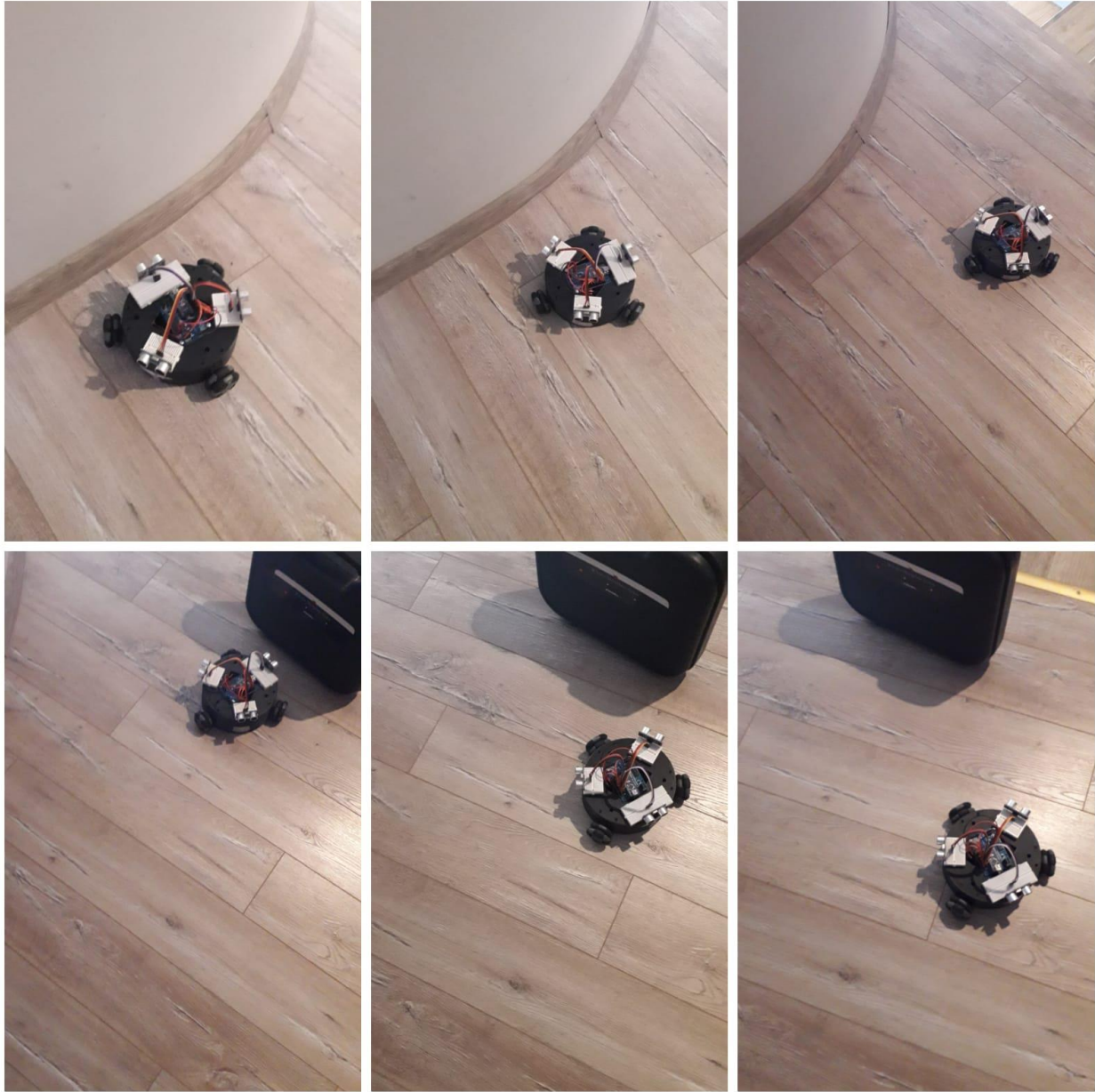
Slika 32: Primjeri izbjegavanja prepreka svesmjernog robota
