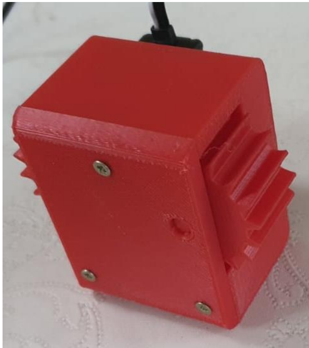
Slika 26: Sastavljen nosač vilica prednja strana
