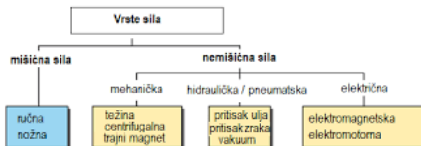
Slika 3. Podjela sile stezanja prema načinu ostvarivanja [1]
