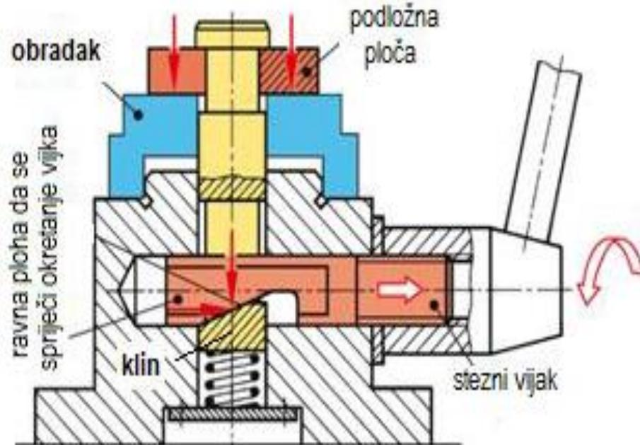
Slika 6. Prikaz steznog klina za zakretanje sile [1]
