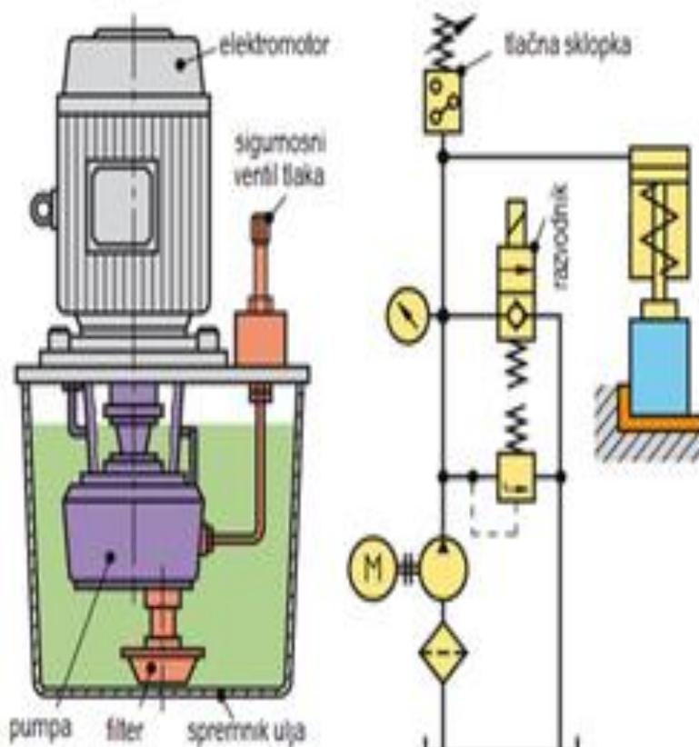
Slika 13. Hidraulički agregat s upravljačkom shemom stezanja [1]
