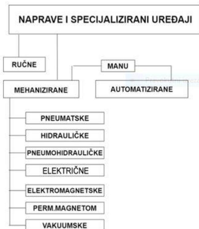
Slika 2. Podjela naprava i specijaliziranih uređaja [2]
