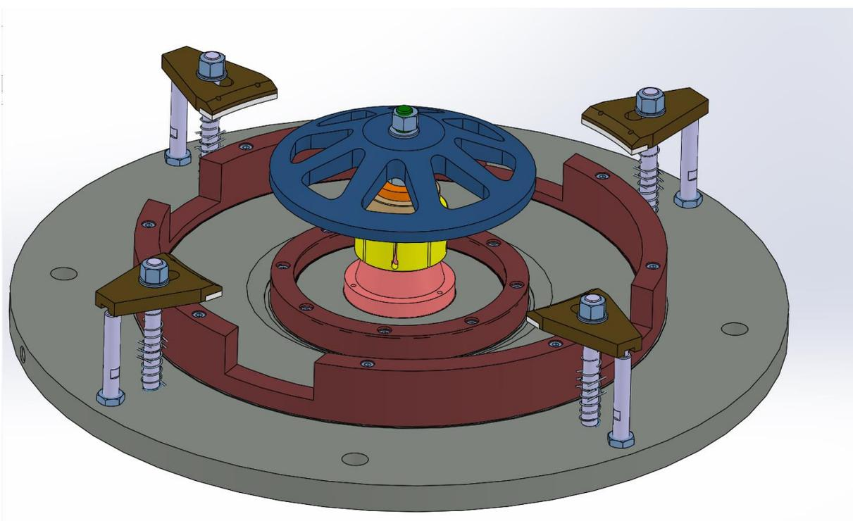
Slika 41. 3D model naprave za tokarenje diska
