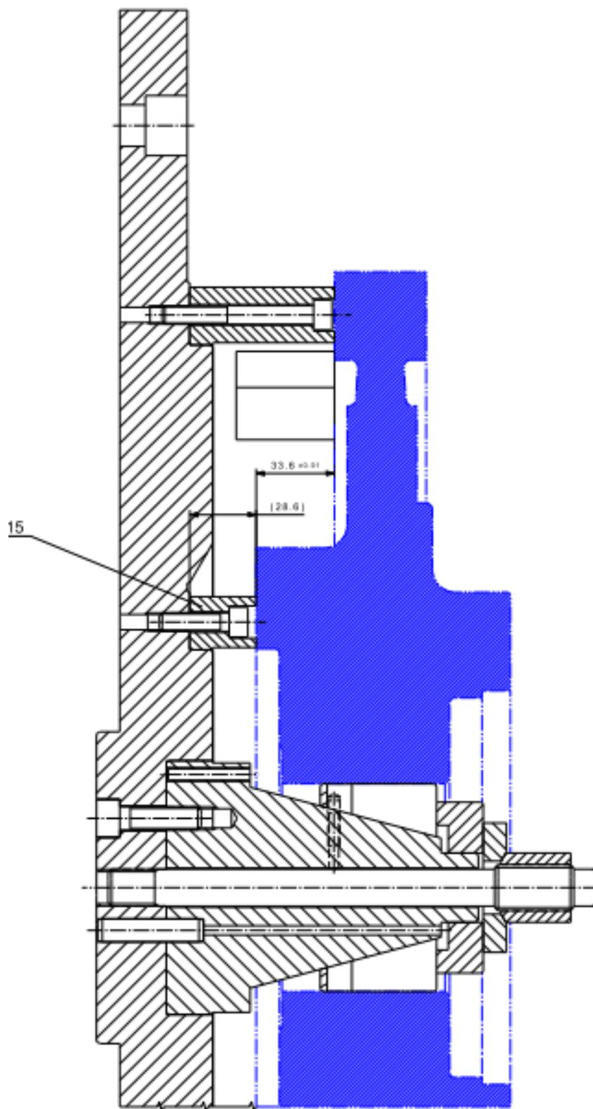
Slika 24. Položaj 2 - diska u steznoj napravi
