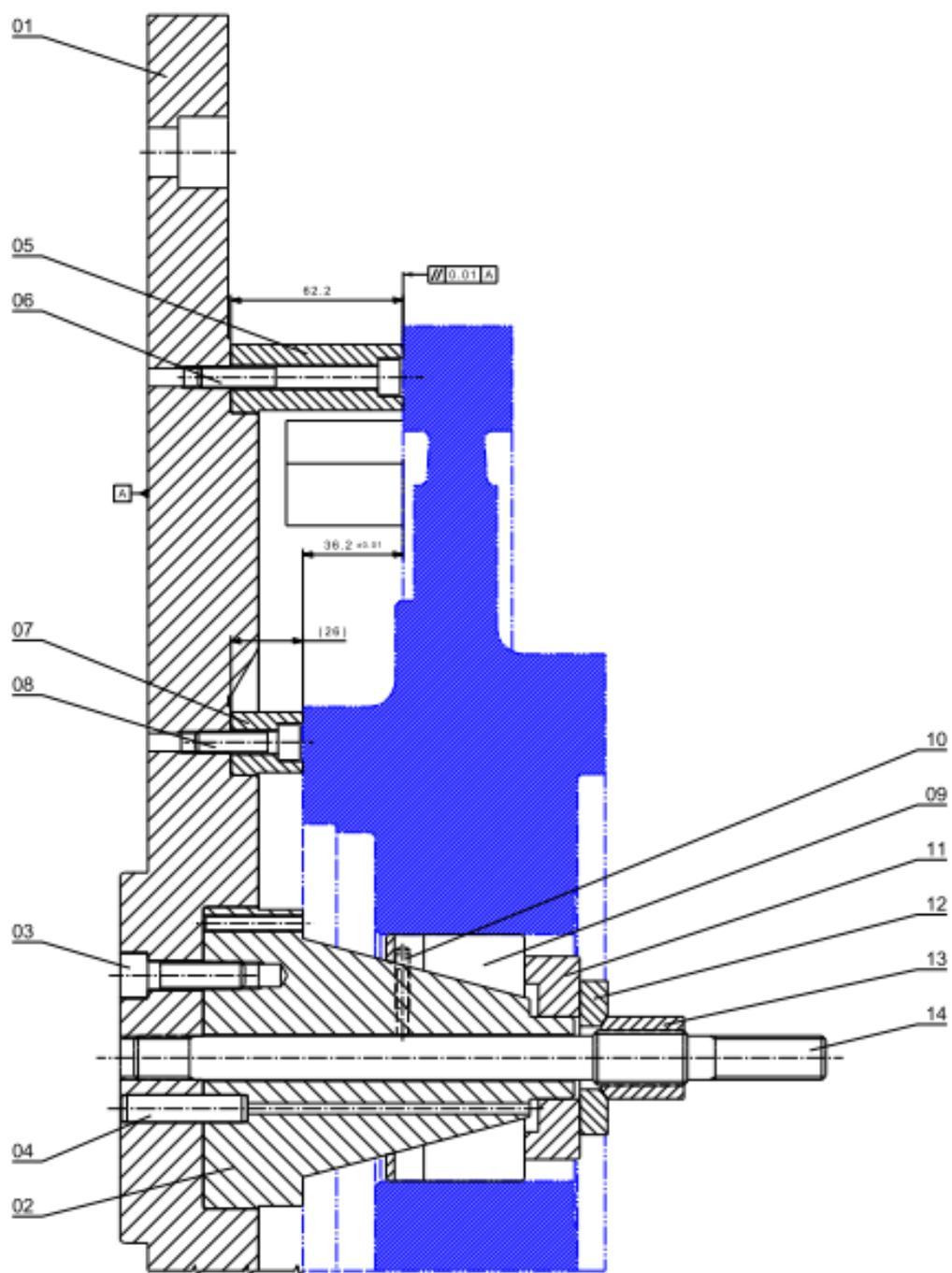
Slika 23. Položaj 1 - diska u steznoj napravi
