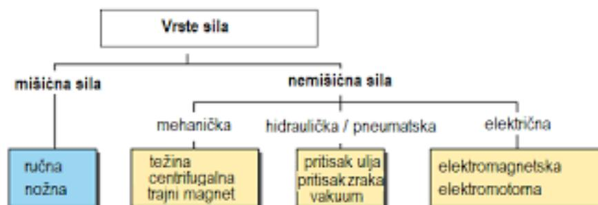
Slika 3. Podjela sile stezanja prema načinu ostvarivanja [1]
