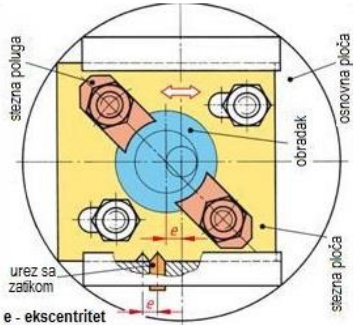
Slika 22. Pomična naprava za ekscentrično stezanje [1]
