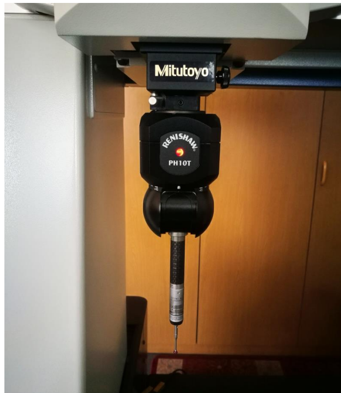
Slika 15. Mjerna glava Renishaw PH10T na TMU-u
