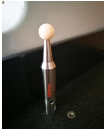
Slika 31. Kugla za umjeravanje
