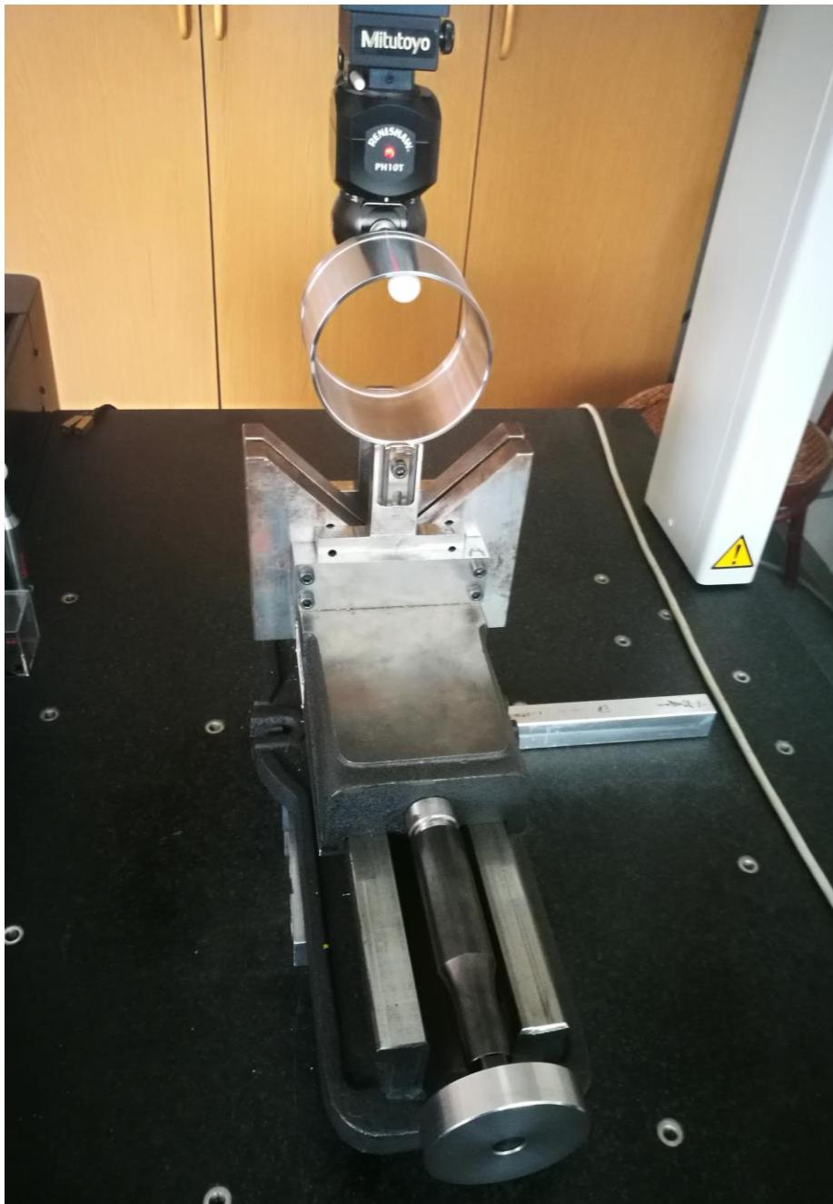
Slika 39. Prikaz mjerjenja prstena rotora
