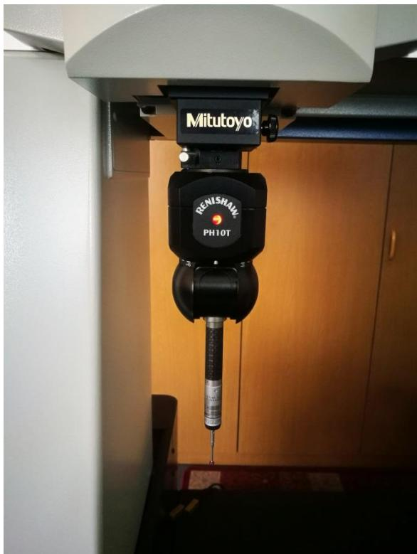
Slika 29. Renishaw PH10T mjerna sonda
