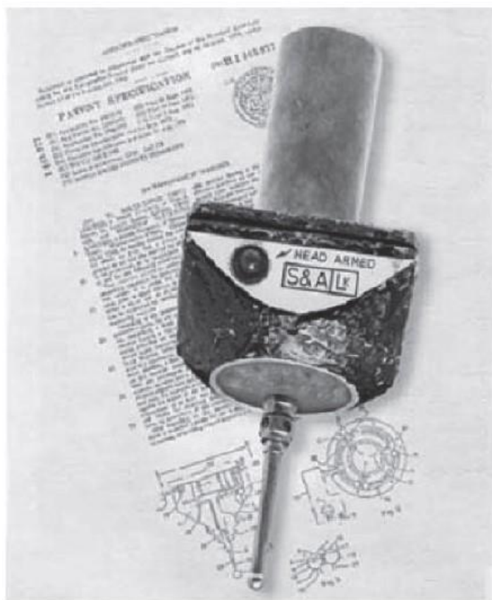
Slika 17. Prvo dodirno mjerno ticalo koje je izumio Sir David McMurtry 1972. godine
