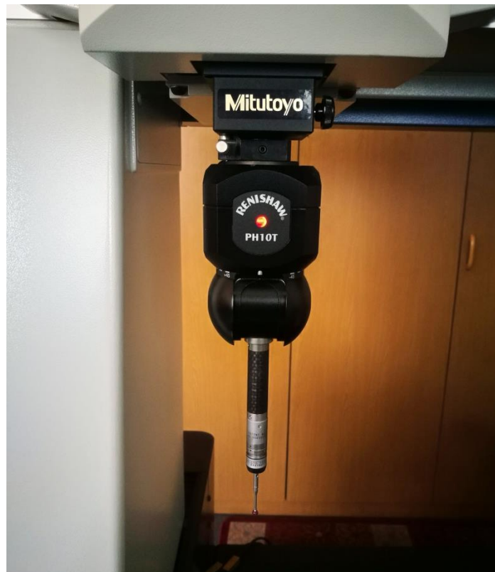
Slika 15. Mjerna glava Renishaw PH10T na TMU-u
