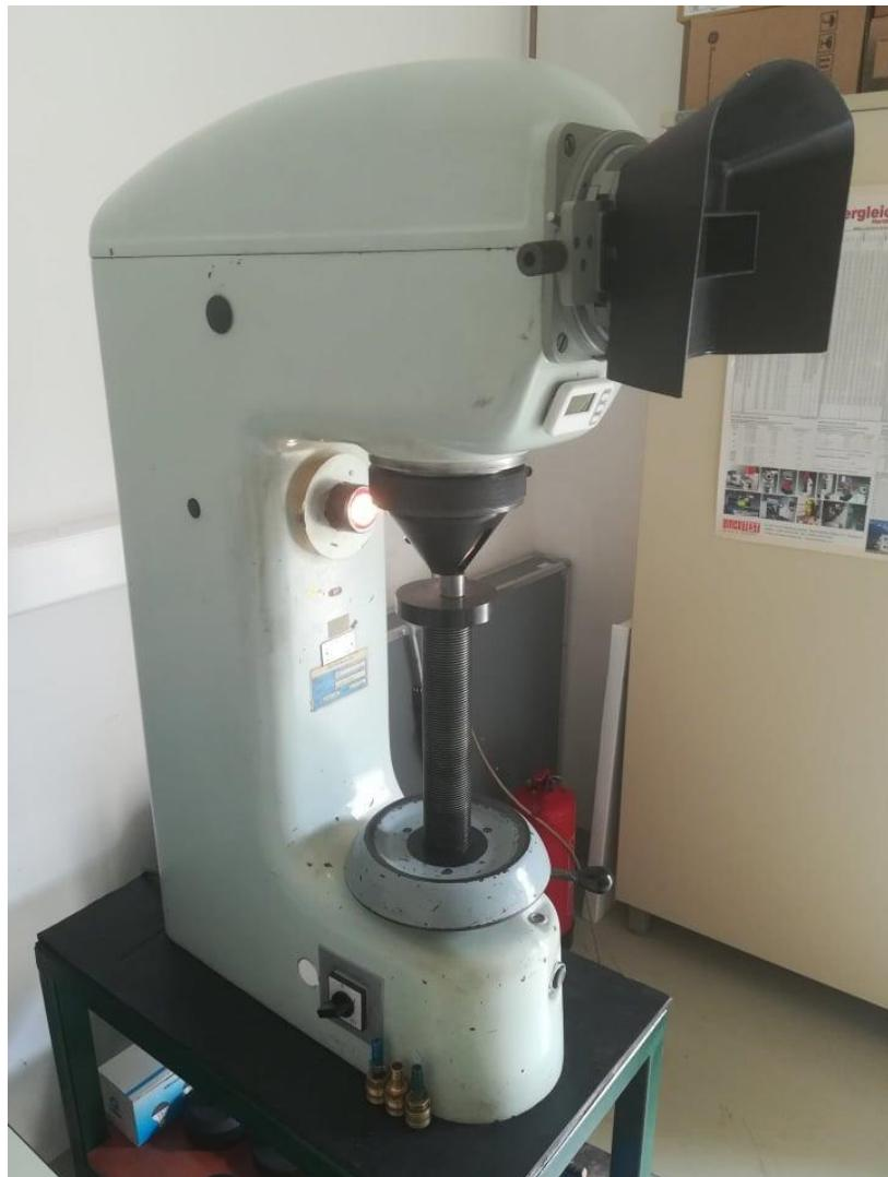
Slika 20. Uređaj za ispitivanje tvrdoće
