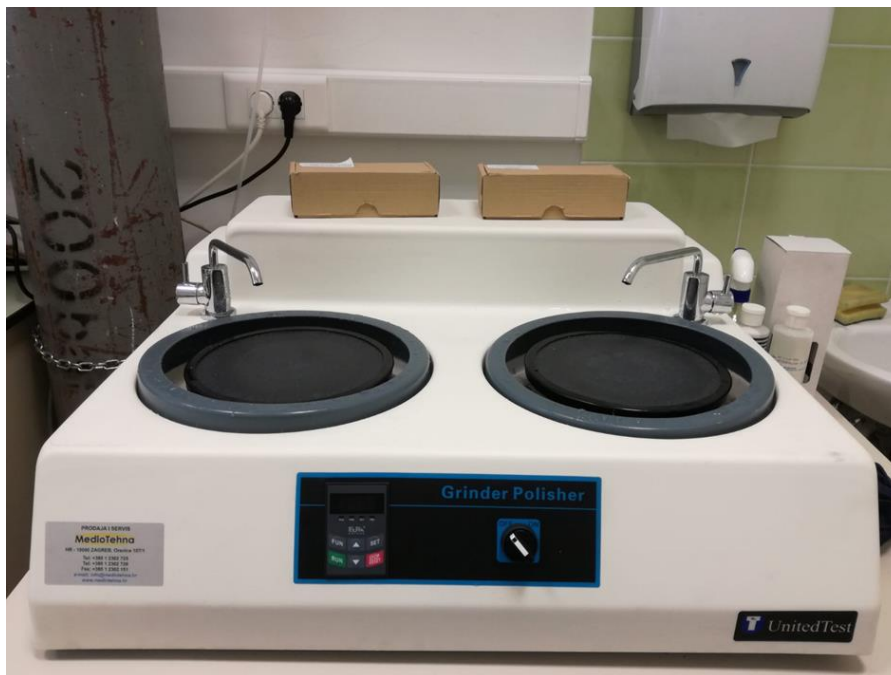
Slika 22. Uređaj za brušenje i poliranje
