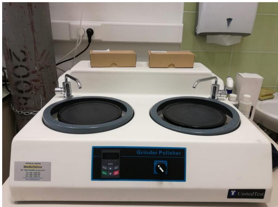
Slika 22. Uređaj za brušenje i poliranje
