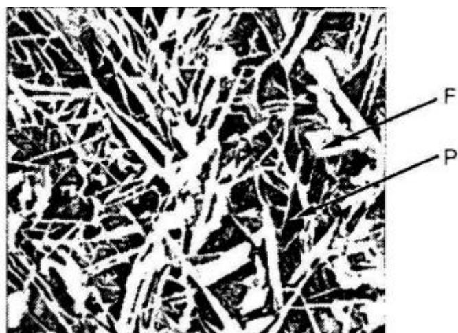
Slika 5. Widmannstättenova mikrostruktura čeličnog ljeva [3]
