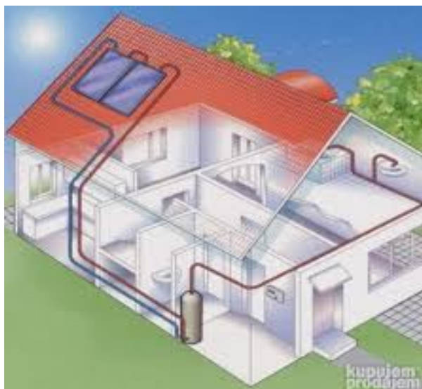
Slika 13. Solarni sustav za toplu vodu
