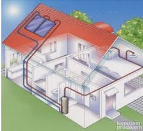
Slika 13. Solarni sustav za toplu vodu
