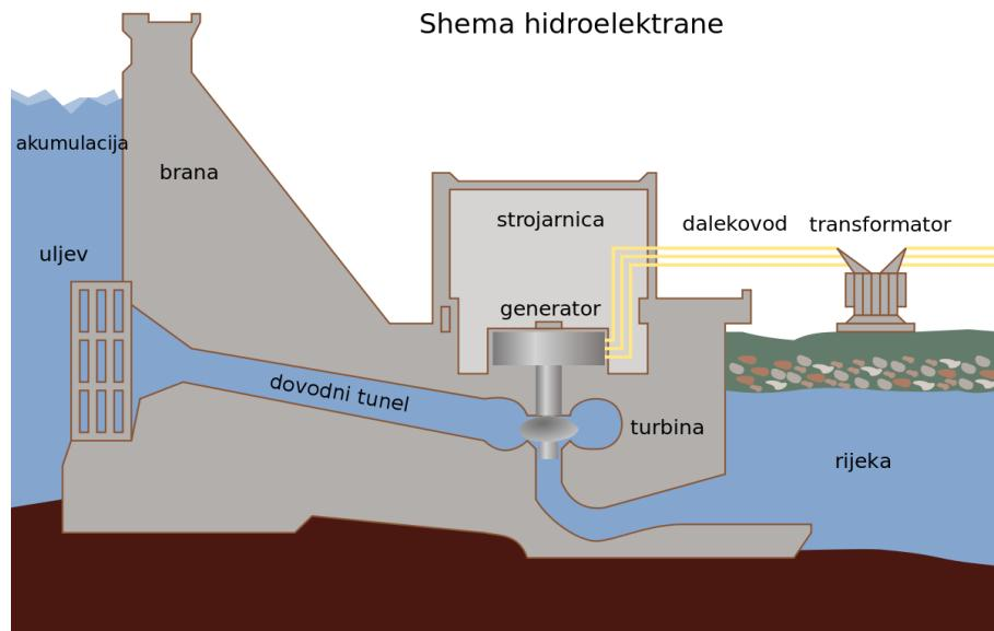
Slika 5. Shema hidroelektrane [11]
