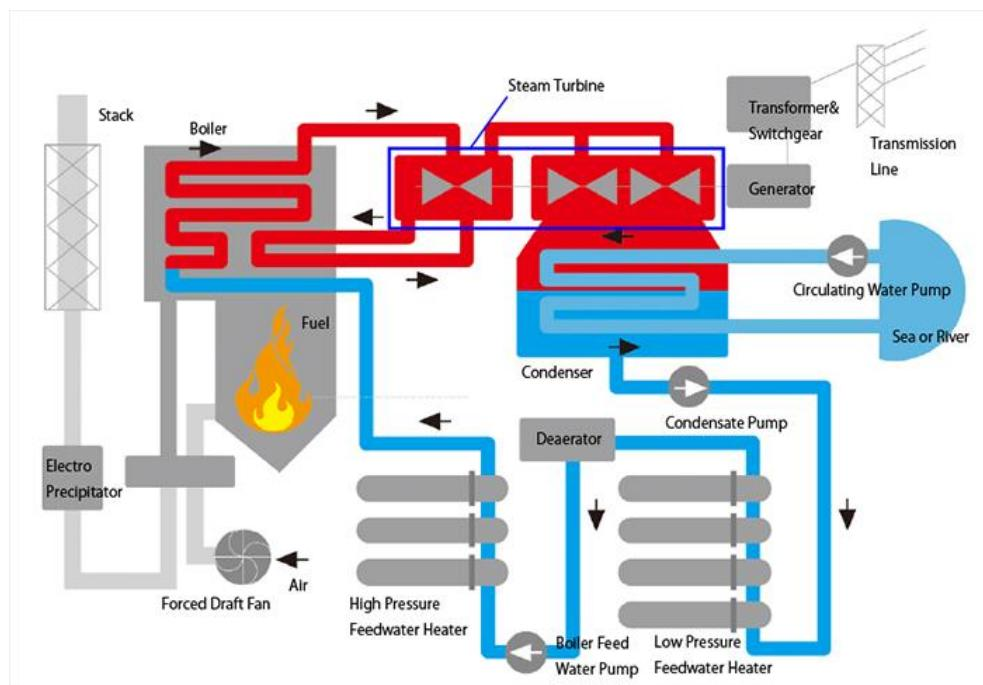
Slika 1. Shema termoelektrane [3]
