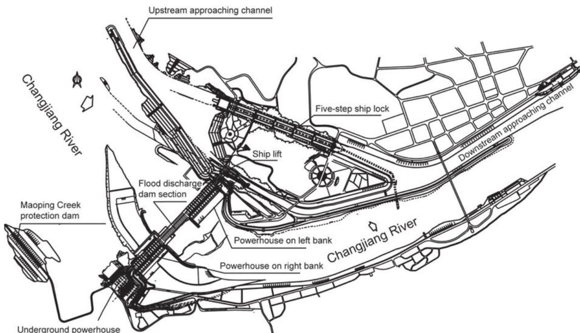
Slika 25. Izgled projekta hidroelektrane Tri klanca [47]
