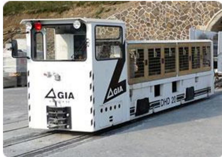
Slika 10. Akulokomotiva za tunelogradnju
