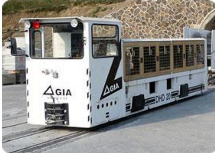
Slika 10. Akulokomotiva za tunelogradnju
