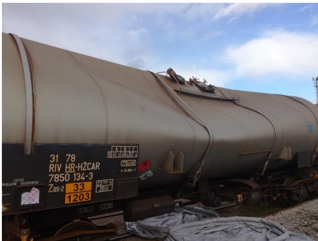
Slika 16. Deformirana oplata vagon cisterne uslijed djelovanja podtlaka.[10]
