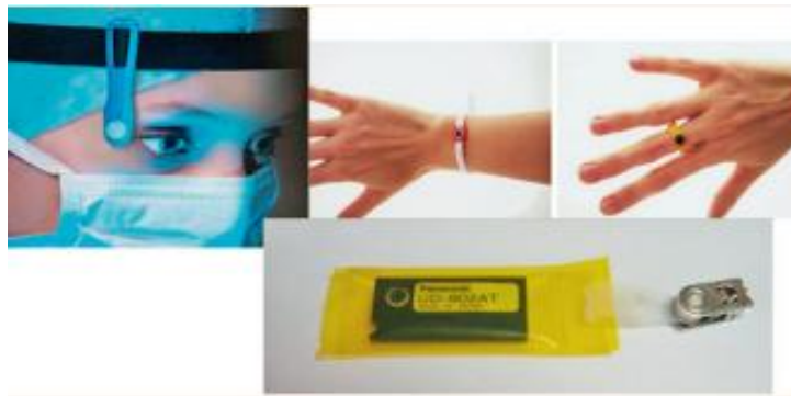
Sl. 10. Termoluminiscentni dozimetri za mjerenje izloženosti očne leće, šake ili kože te cijelog tijela
