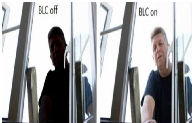
Slika 11. Predodžba slike bez i sa BLC-om: Izvor http://sigurnosni-sustavi.hr/tehnologija/hrvatska/klasicni-video-nadzor
