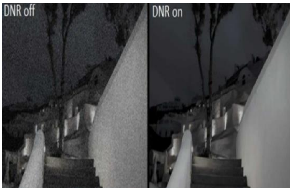
Slika 10. Predodžba slike bez i sa redukcijom šuma: Izvor http://sigurnosni-sustavi.hr/tehnologija/hrvatska/klasicni-video-nadzor
