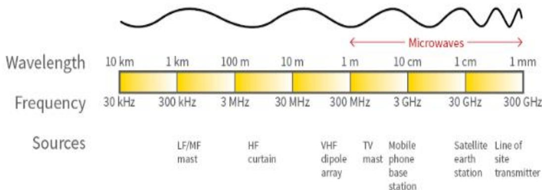
Slika 2. Radiofrekventni spektar zračenja [9]
