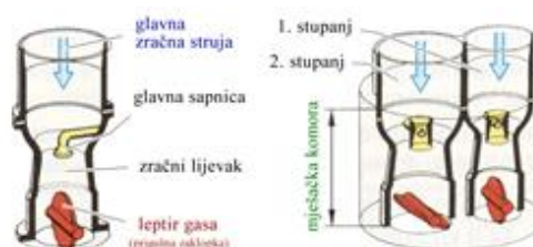
Slika 22. Jednostavni i registarski karburator
