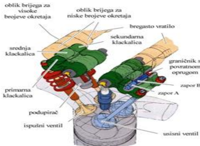
Slika 6. Varijabilno podizanje ventila
