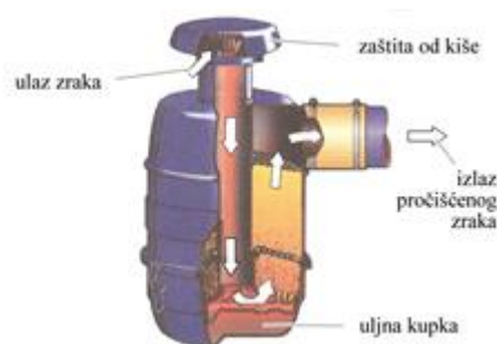
Slika 18. Filter zraka s uljnom kupkom
