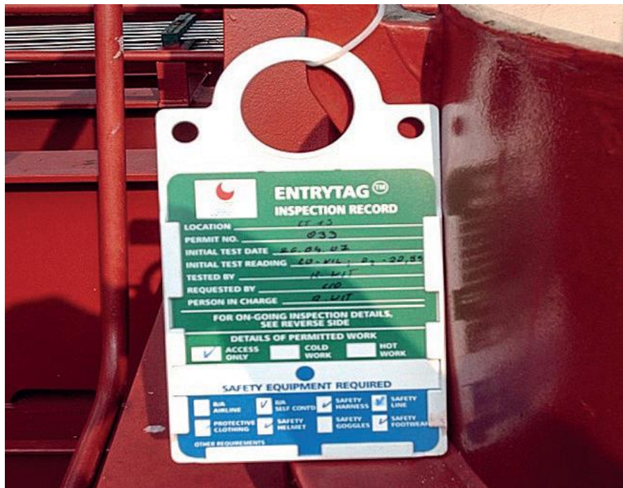
Slika 2. Oznaka unosa prikazana na ulazu u zatvoreni prostor koja sažima da je dozvolu za ulazak dala nadležna/odgovorna osoba
