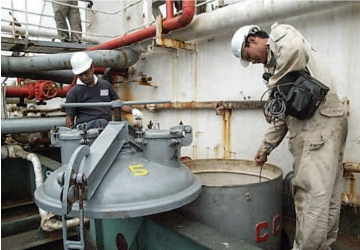
Slika 5. Ispitivanje atmosfere zatvorenog prostora
