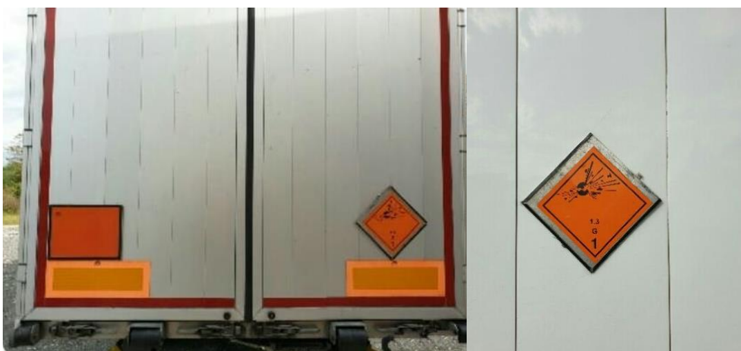
Sl. 7. Označavanje vozila listicama opasnosti na stražnjoj strani vozila [9]
