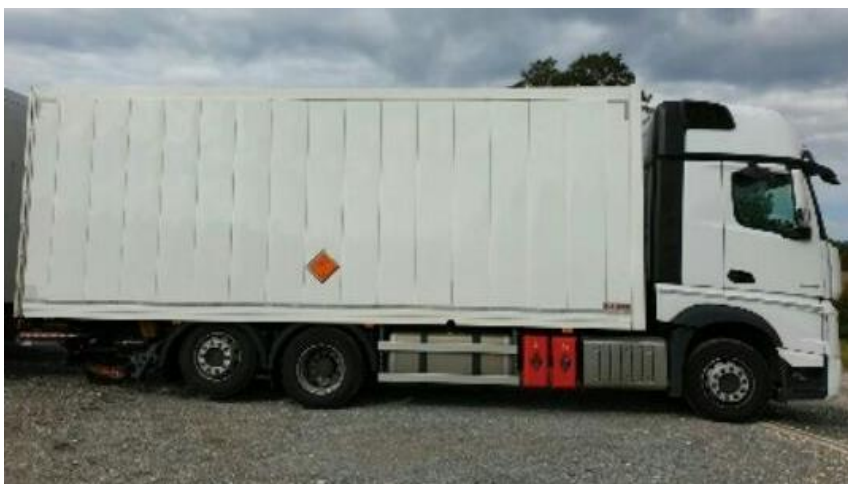
Sl. 6. Označavanje vozila listicama opasnosti na bočnoj strana vozila [9]
