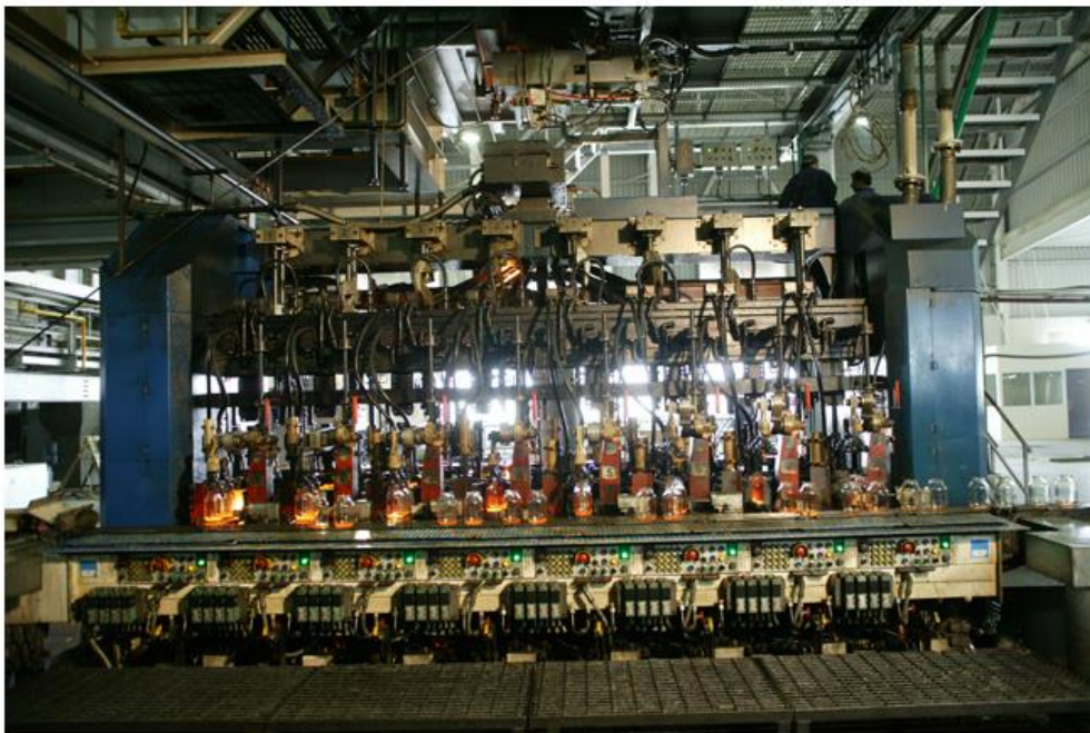
Slika 8. Linijski stroj tipa IS [3]
