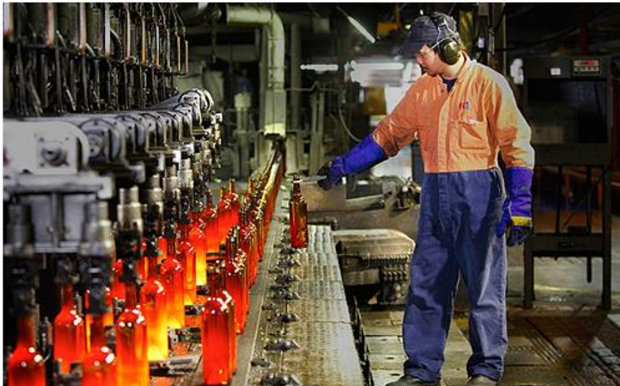
Slika 10. Tehnolog uzima bocu i nosi na ispitivanja [3]
