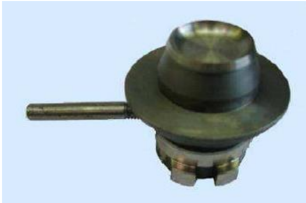
Slika 15. a) Dno predkalupa dvodjelno[1]
