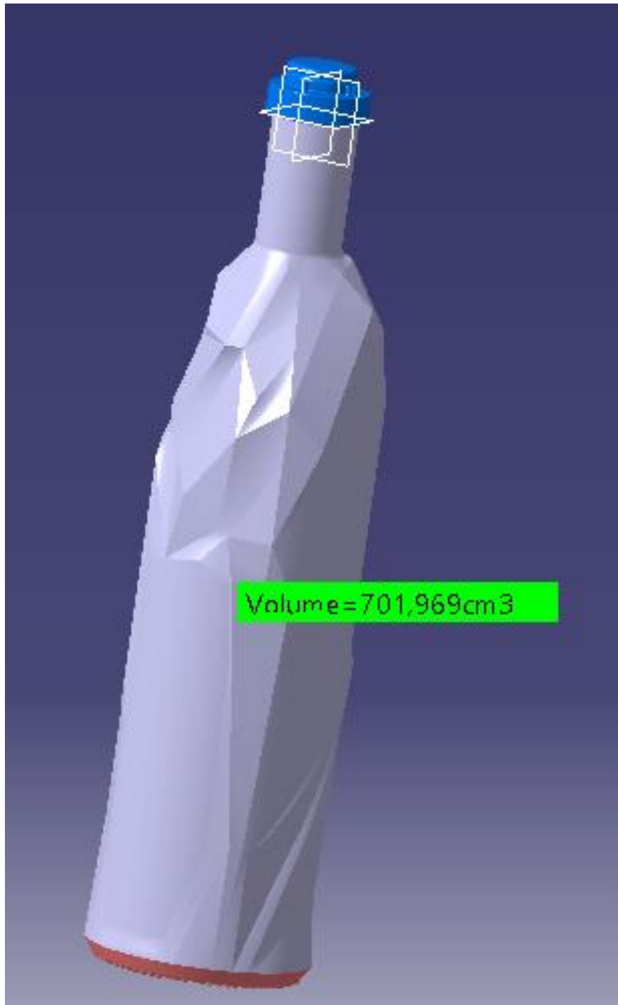
Sl. 53. Konačni izgled 3D modela nakon podešenja volumena
