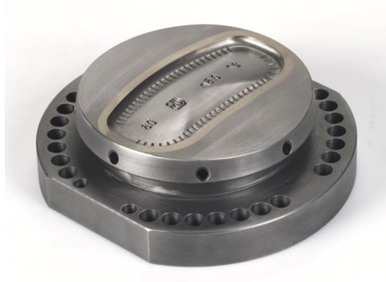
Slika 13.a) Dno kalupa (Al-bronca) [1] Slika 13. b) Dno kalupa (sivi lijev SL 25) [1]
