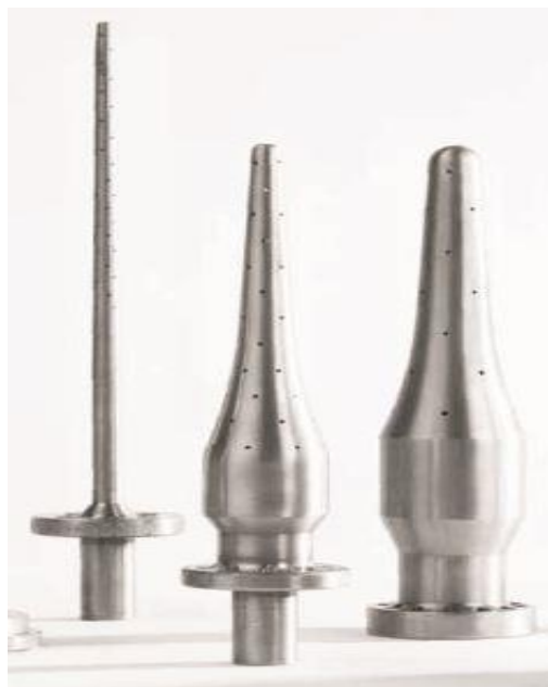
Slika 20. Umetak za hlađenje jezgrena [1]
