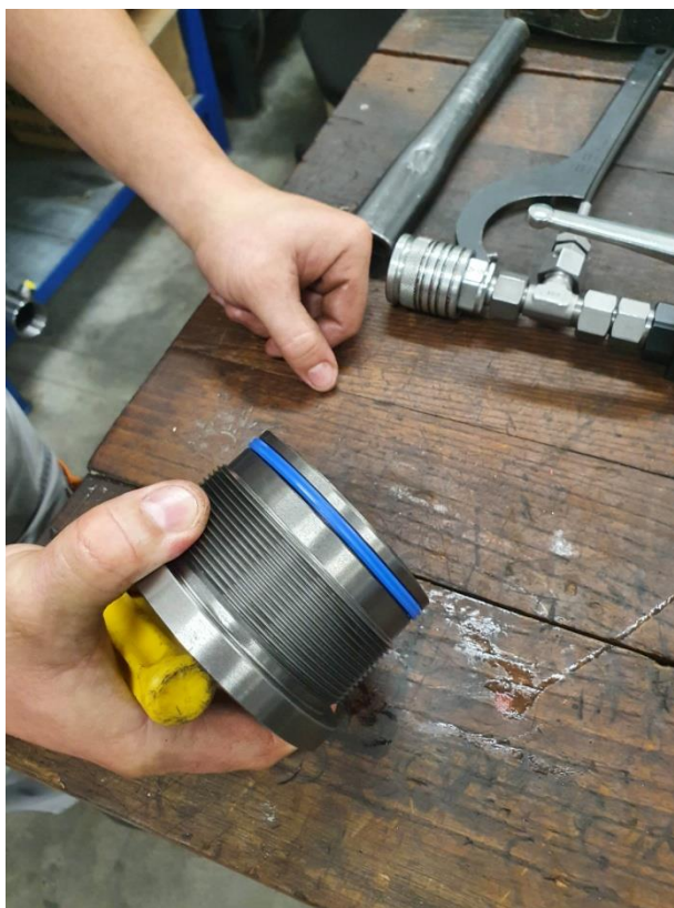
Slika 70. Montiranje vanjske brtve.
