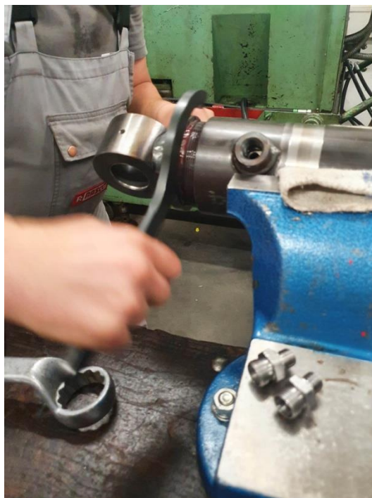
Slika 87. Stezanje usta cilindra.
