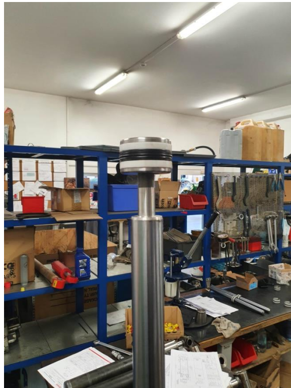
Slika 76. Montaža klipa na klipnjaču.
