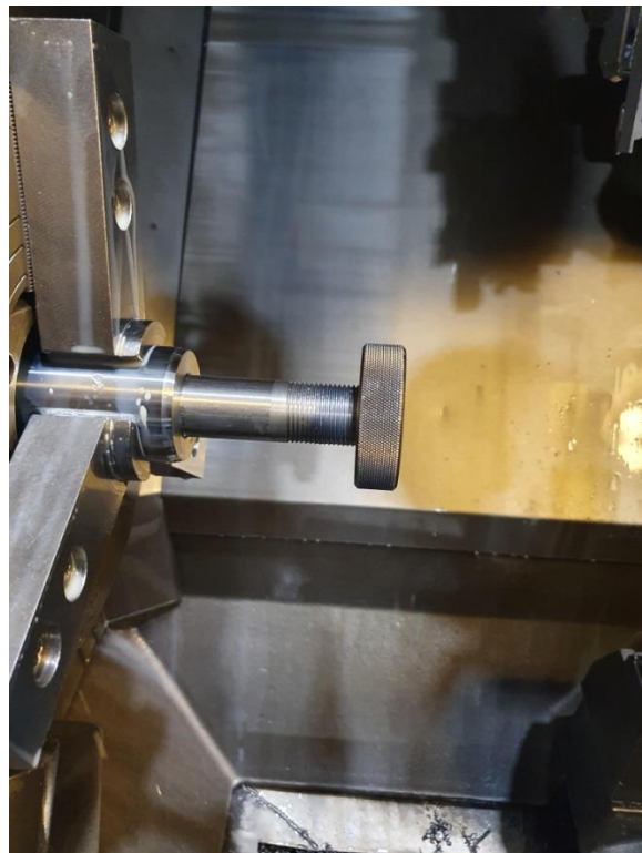
Slika 41. Provjera debljine navoja.
