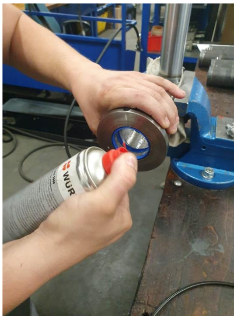
Slika 71. Podmazivanje ustiju cilindra.
