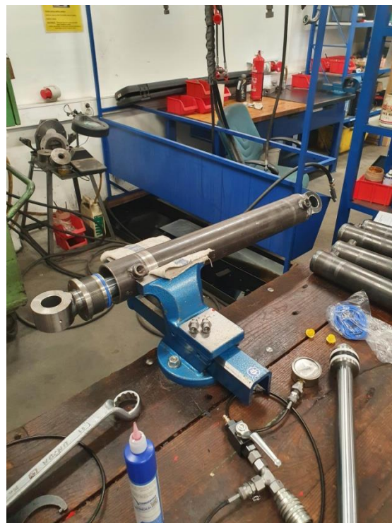
Slika 84. Stavljanje klipnjače unutar cijevi cilindra.
