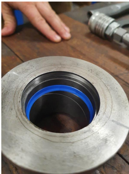
Slika 69. Montiranje unutarnje brtve.
