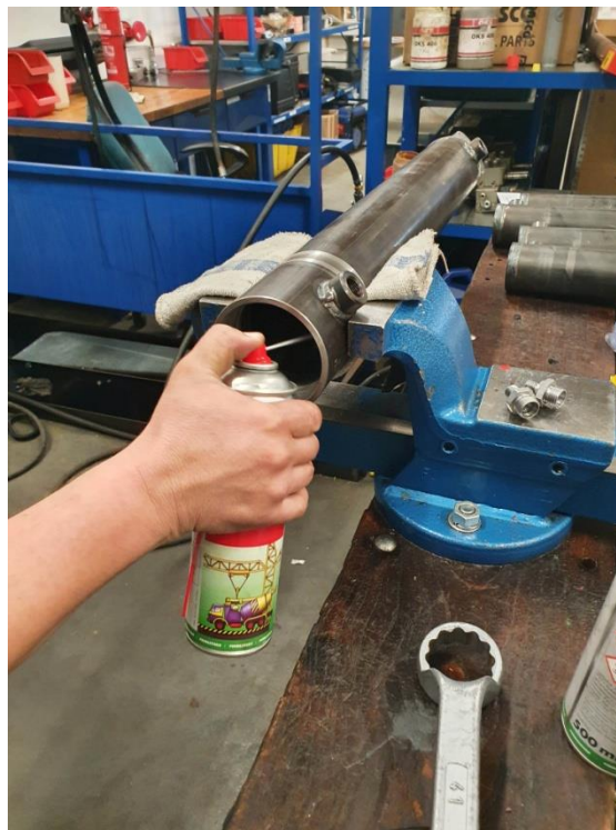
Slika 83. Podmazivanje unutarnjeg navoja na cijevi cilindra.
