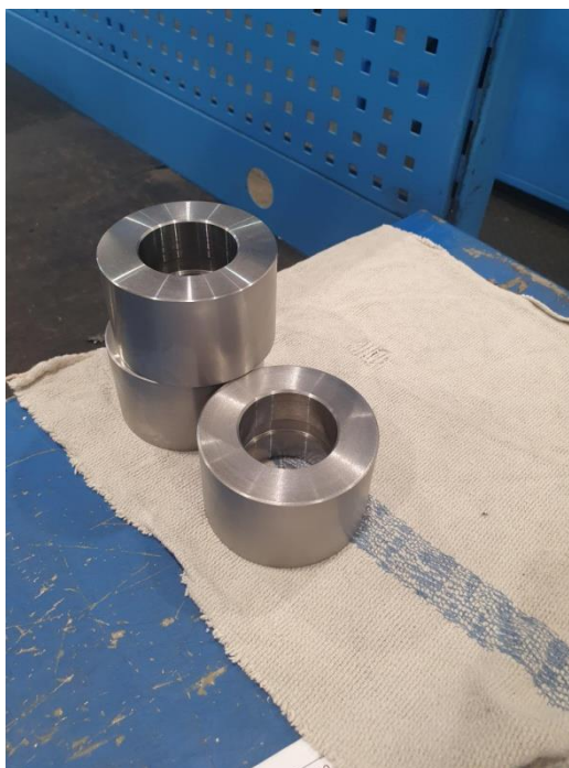
Slika 45. Izgled oka klipnjače nakon tokarenja.
