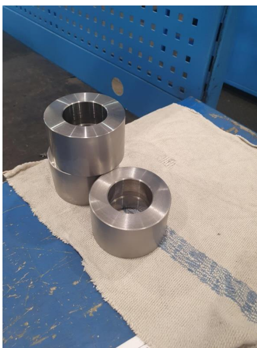
Slika 45. Izgled oka klipnjače nakon tokarenja.
