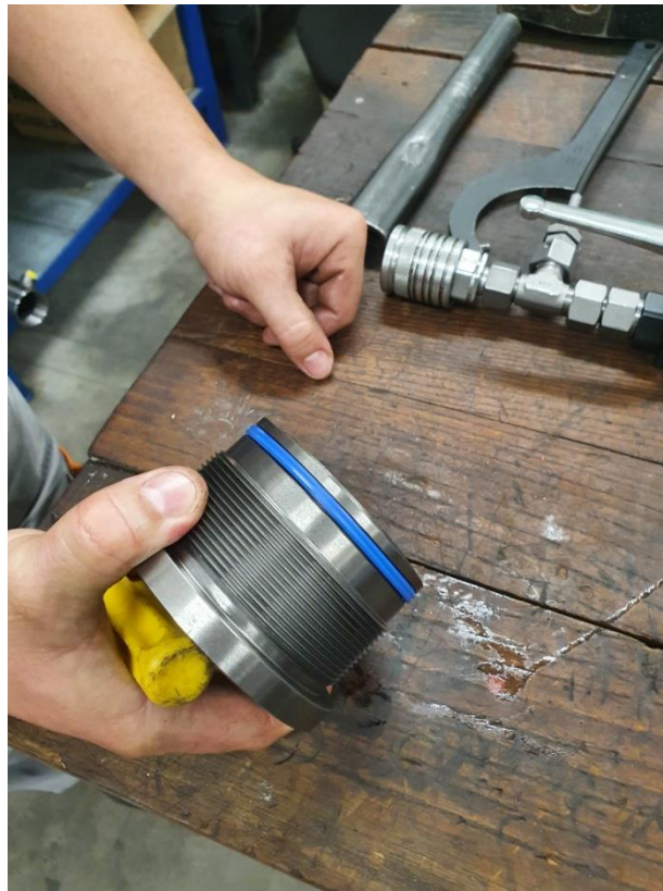
Slika 70. Montiranje vanjske brtve.
