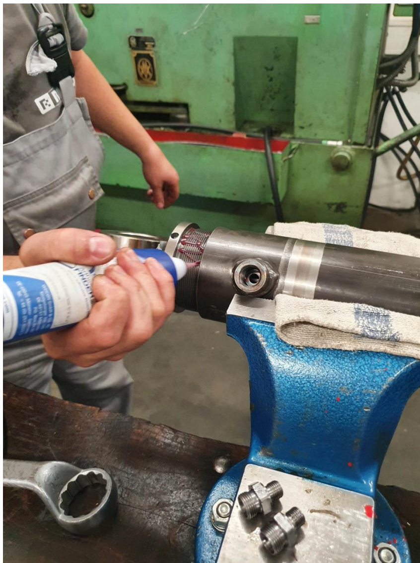
Slika 85. Nanošenje ljepila na navoj usta cilindra
