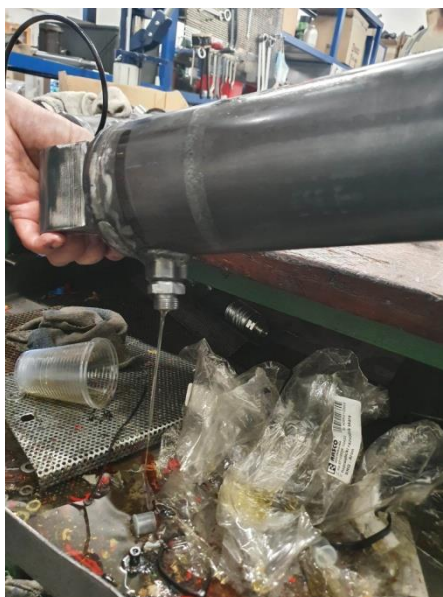
Slika 97. Ispuštanje ulja iz cilindra.
