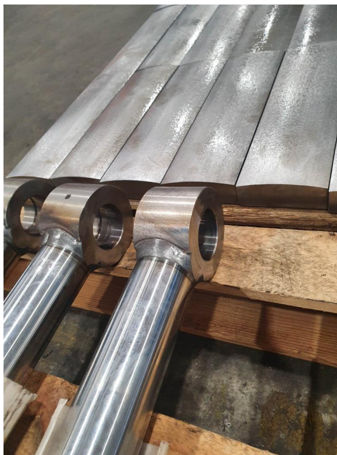
Slika 49. Izgled klipnjače nakon zavarivanja.
