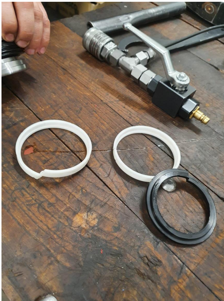
Slika 66. Brtva klipa cilindra.
