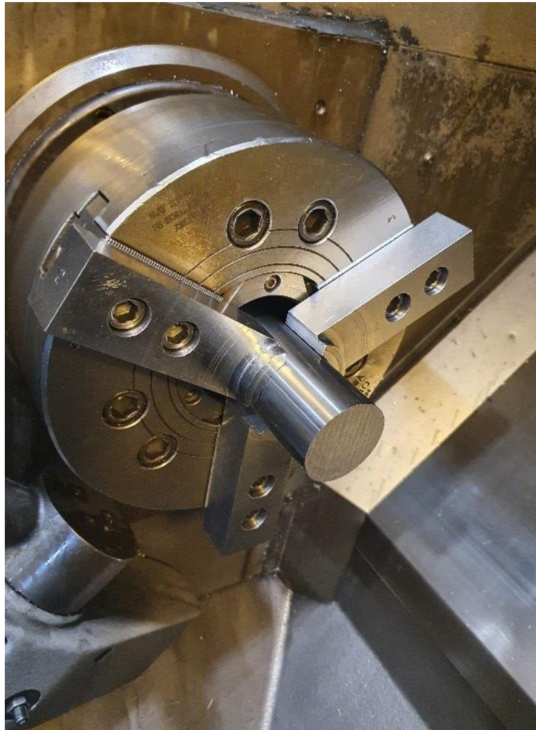
Slika 36. Stezanje obratka u steznu glavu.
