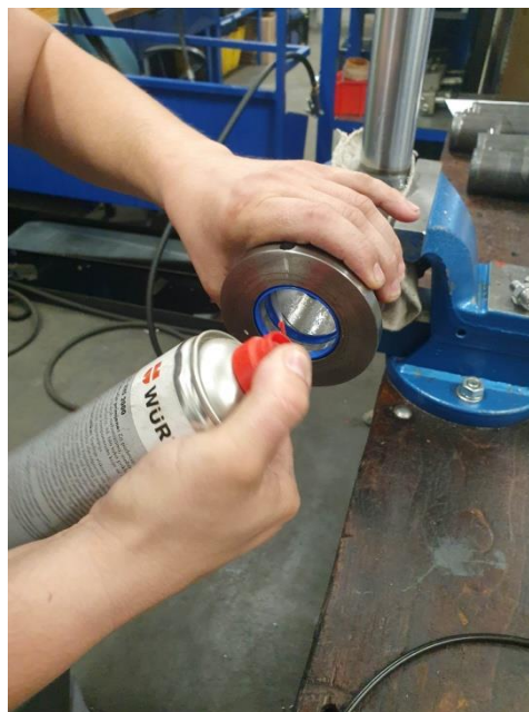
Slika 71. Podmazivanje ustiju cilindra.
