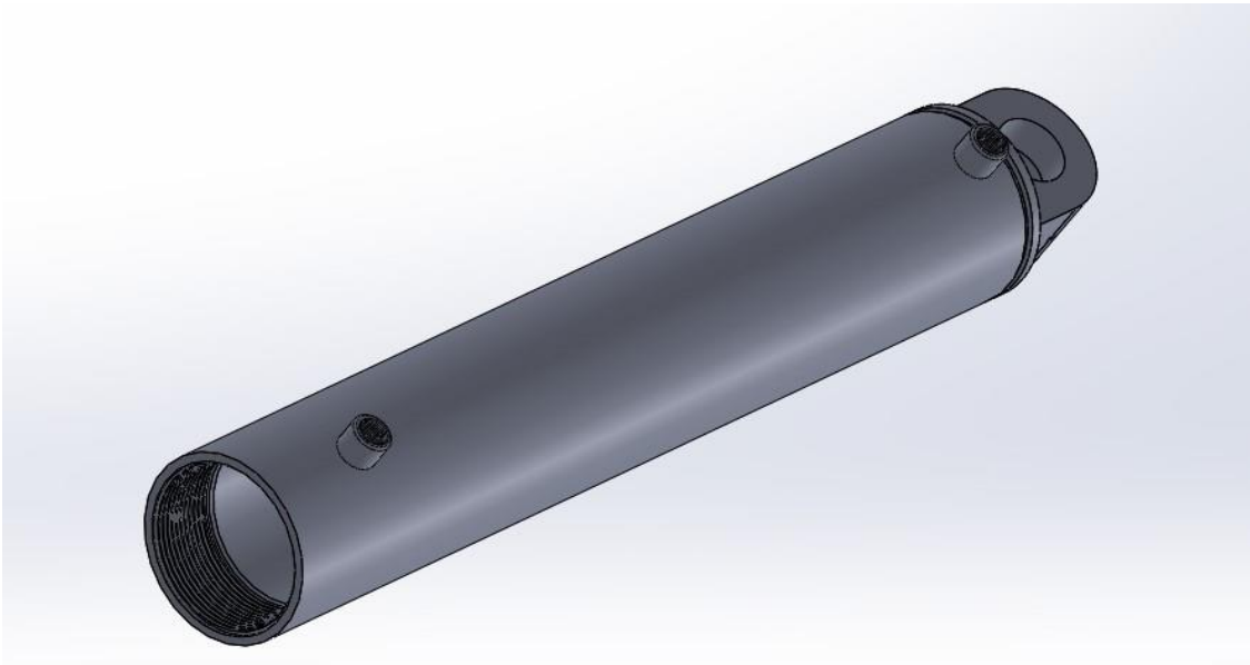
Slika 26. 3D računalni model sklopa cijevi cilindra.
