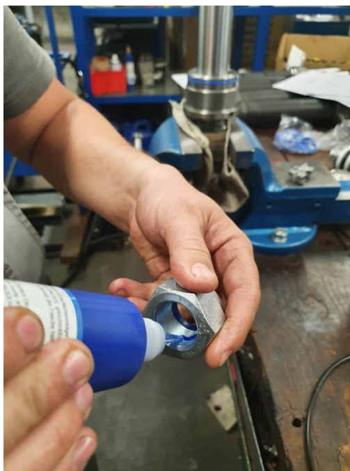
Slika 78. Nanošenje ljepila na maticu.
