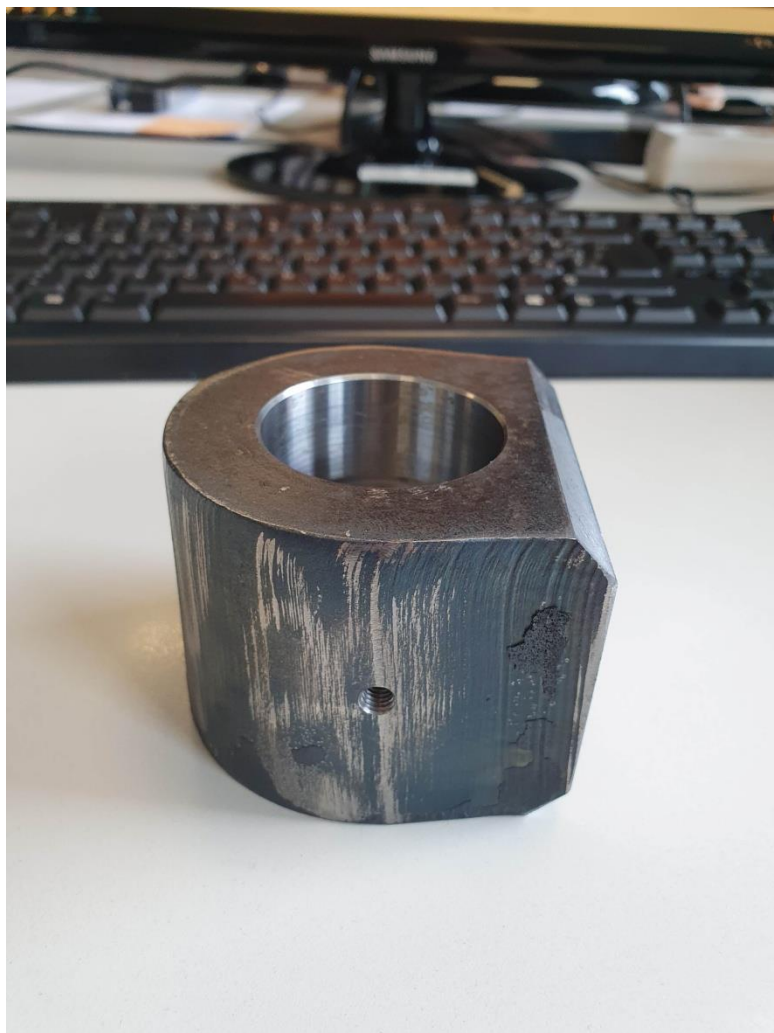
Slika 60. Gotova glava cilindra.
