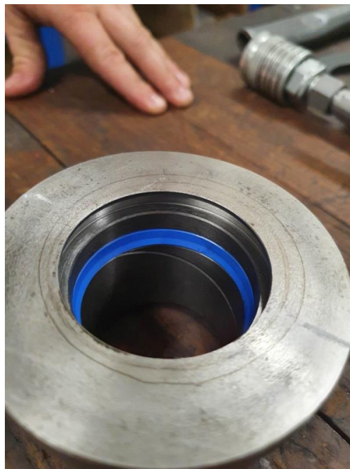
Slika 69. Montiranje unutarnje brtve.
