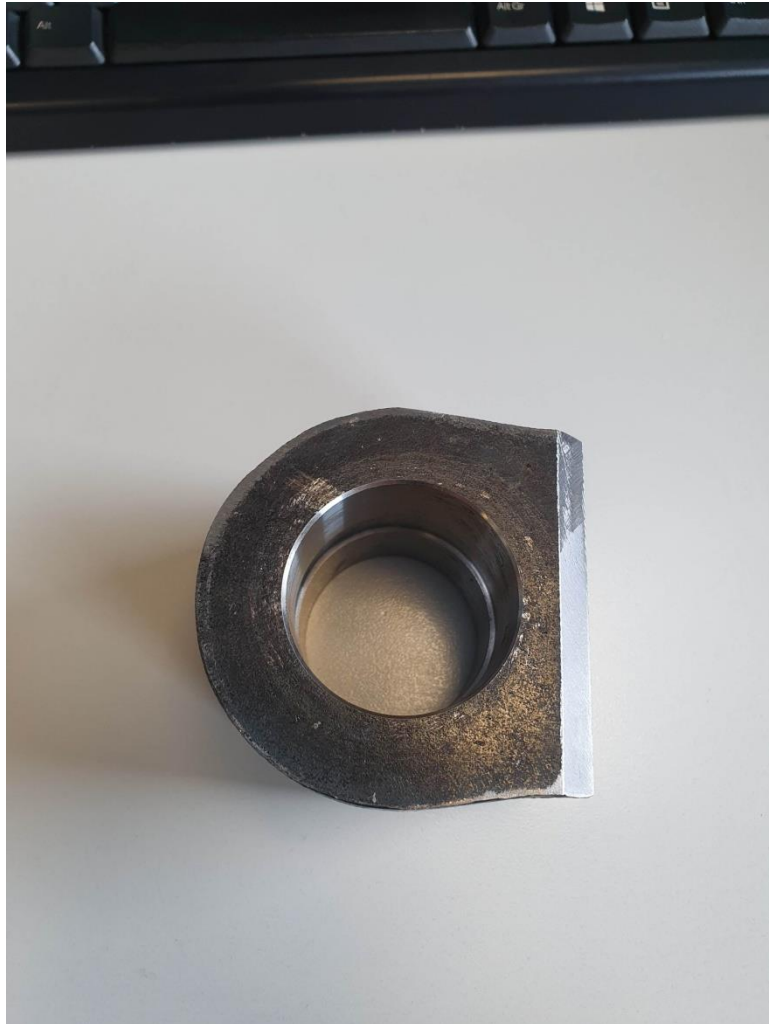
Slika 59. Obradak nakon tokarenja.
