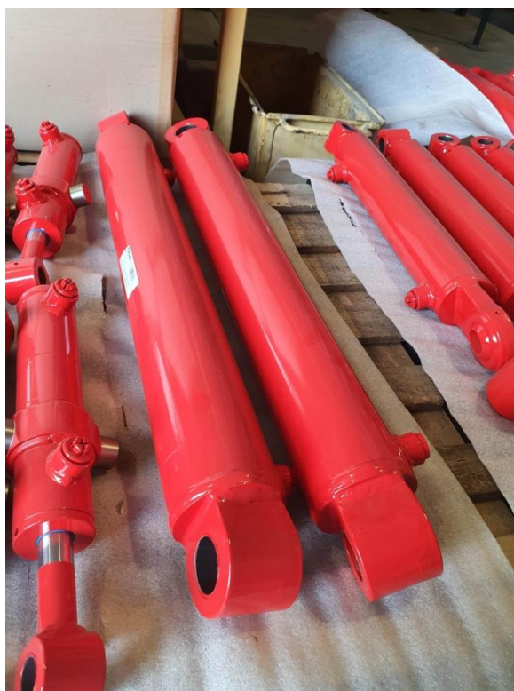
Slika 99. Cilindar nakon bojanja.
