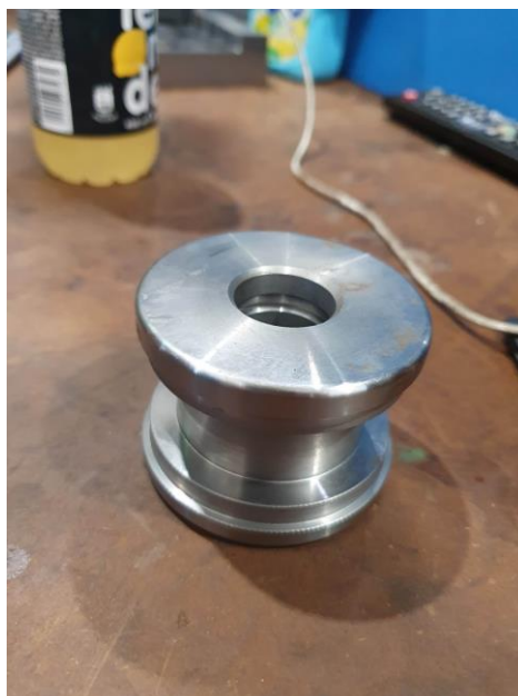
Slika 55. Klip cilindra \varnothing 100 / \varnothing 27
