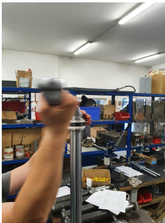
Slika 81. Stezanje matice okastim koljenastim ključem.
