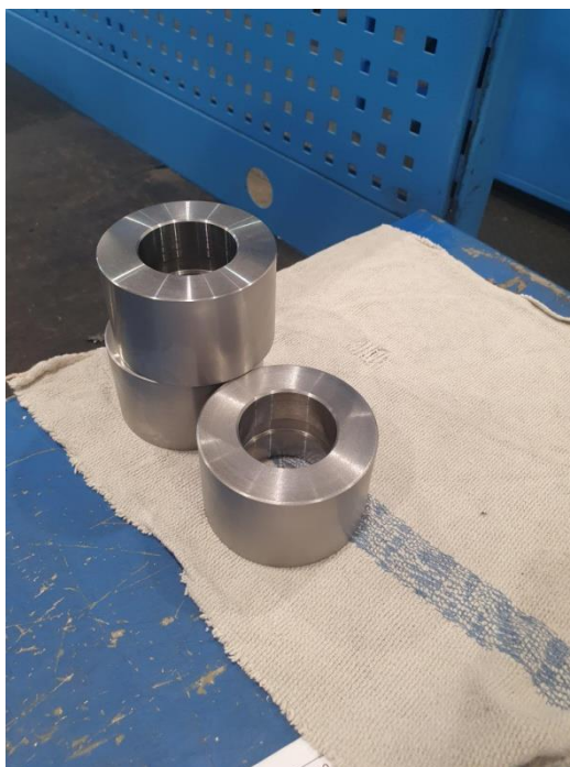
Slika 45. Izgled oka klipnjače nakon tokarenja.
