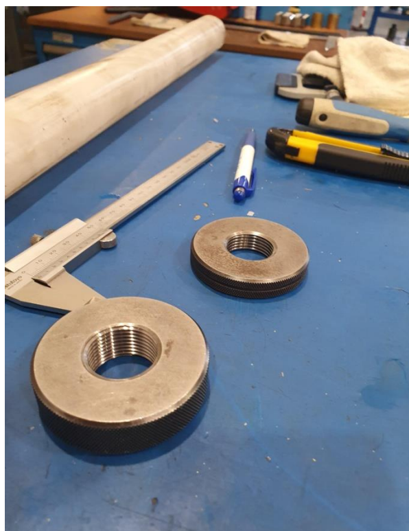
Slika 41. Provjera debljine navoja.
