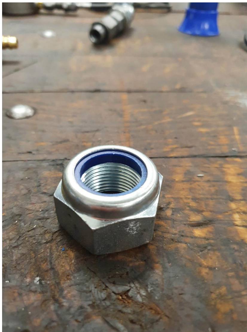
Slika 77. Matica za stezanje klipa na klipnjaču.
